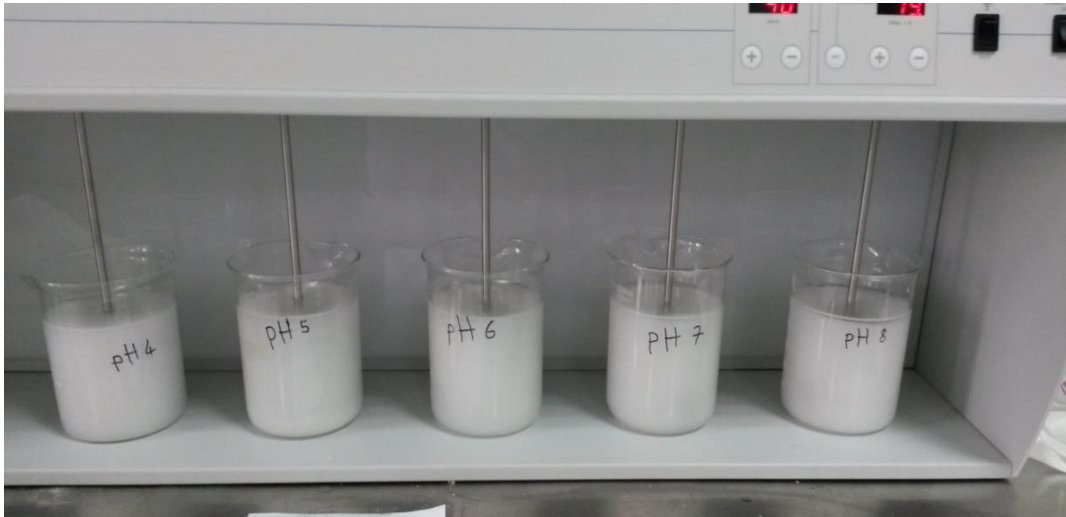
Şekil 3.3. Kimyasal koagülasyon deney düzeneği
