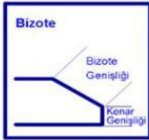
Şekil 2.3. Bizote işleminin şematik gösterimi
