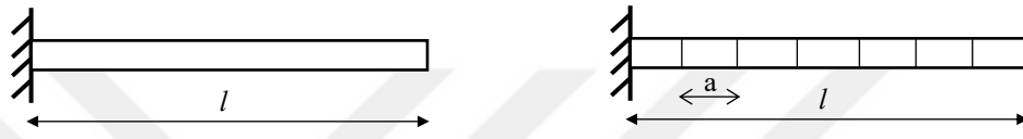
Şekil 5.2. Duvara ankastre asılı bir kirişin sürekli ve sonlu parçalara ayrılmış modeli
