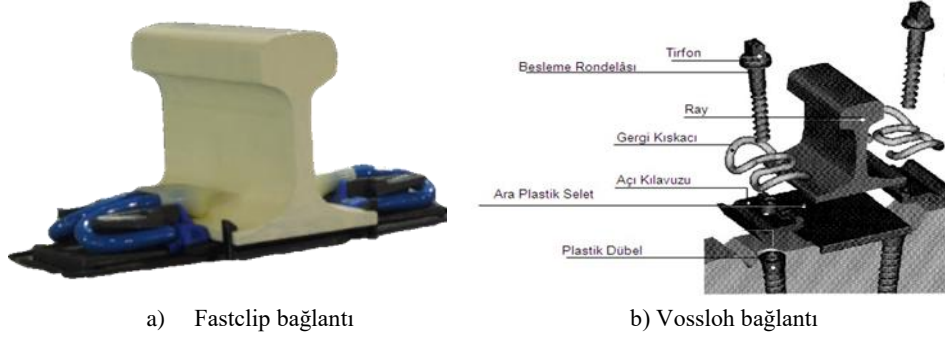
Şekil 3.27. Rayın traverse bağlantısı
