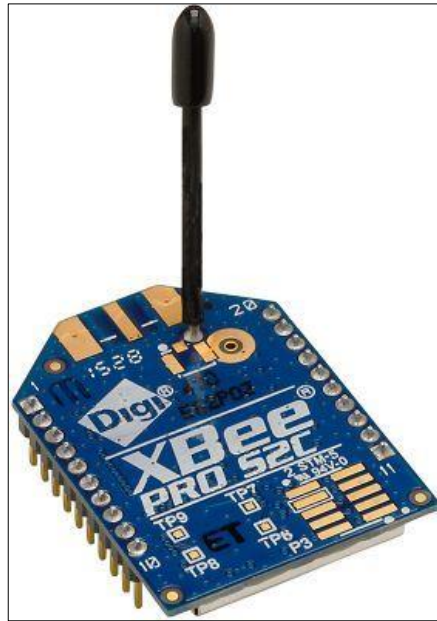
Şekil 4.9. ZigBee iletişim ağı için kullanılan Xbee modül.
