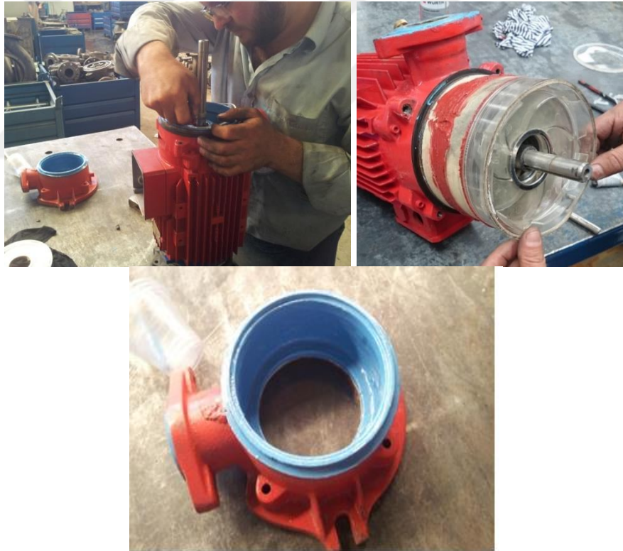
Şekil 3.14. Pompa elemanlarının seramik malzemeler ile kaplanması ve montajı.
