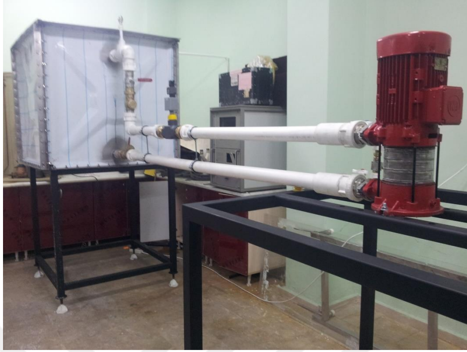
Şekil 3.16. PIV düzeneği pompa tesisatı.
