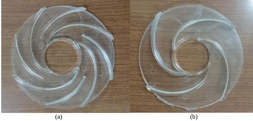
Şekil 3.11. (a) ara kanat ilaveli 4 kanatlı (çark 2) ve (b) 4 kanatlı (çark 3).
