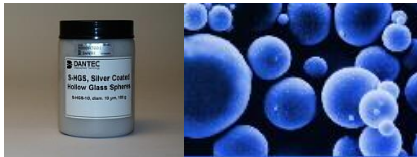
Şekil 3.23. Gümüş kaplı küresel partiküller ve mikroskopik görüntüsü (Anonymous, 2017a).
