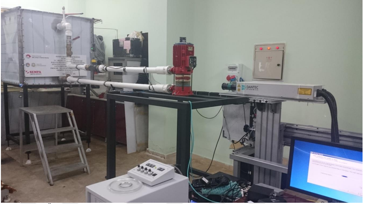
Şekil 3.24. S.Ü. Makina Mühendisliği Bölümü Hidrolik-PIV laboratuvarında kurulan PIV deney sistemi .
