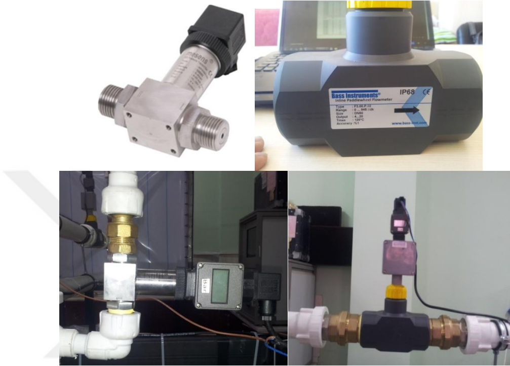
Şekil 3.17. Fark basınç trans미터i (üstte), debimetre (altta) ve sisteme montaj halleri.
