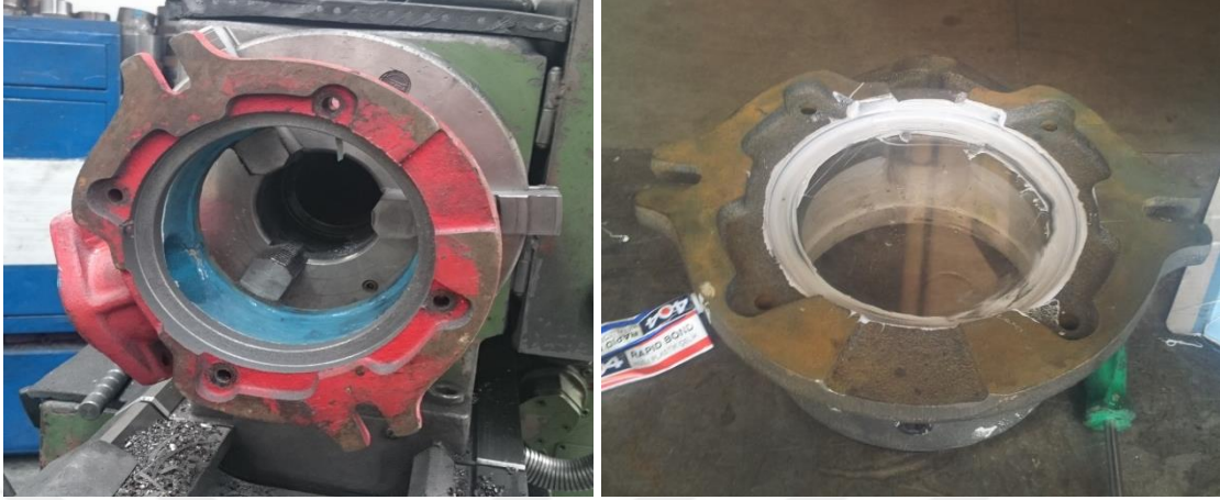
Şekil 3.13. Pompa emiş kısmının tornada açılması ve pleksiglas malzeme ile kapatılması.
