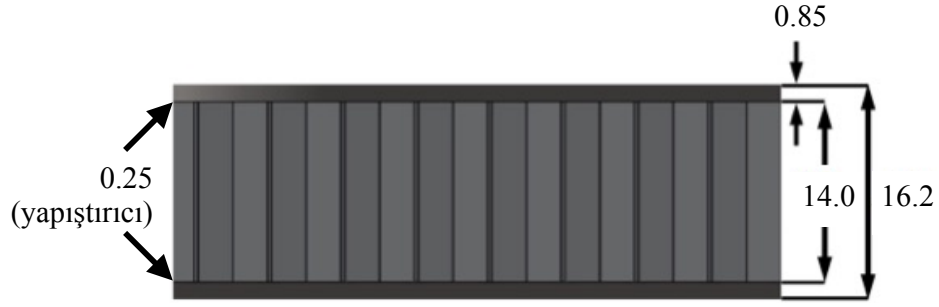
Şekil 8.2 Büyük hücreli bal peteği sandviç plakanın katman ölçüleri (mm), kapak-yapıştırıcı-bal peteği-yapıştırıcı-kapak
