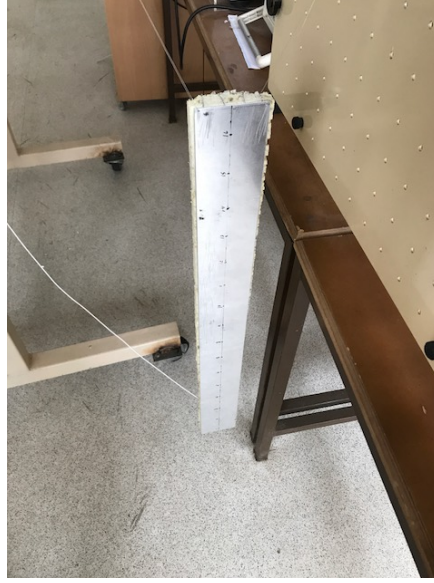
Şekil 9.2 Deney için asılan köpük ile doldurulmuş büyük hücreli bal peteđi
