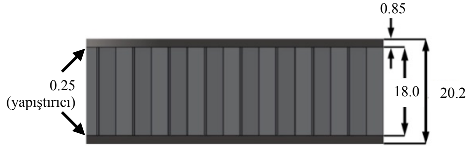
Şekil 7.3 Küçük hücreli bal peteği sandviç plakanın katmanları (kapak - yapıştırıcı - bal peteği - yapıştırıcı - kapak) ve ölçüleri (mm)
