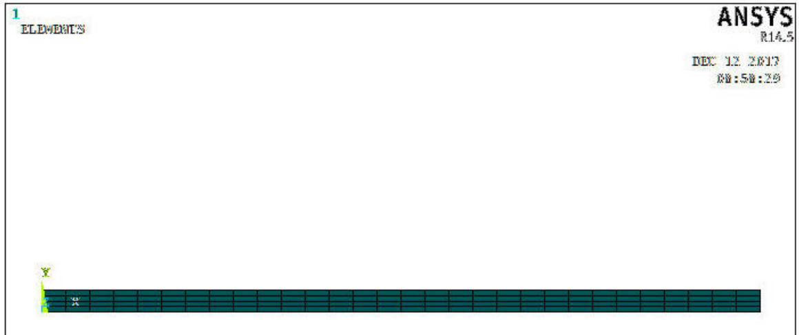
Şekil 6.3 Çelik çubuk, elemanlar ve serbest sınır şartı
