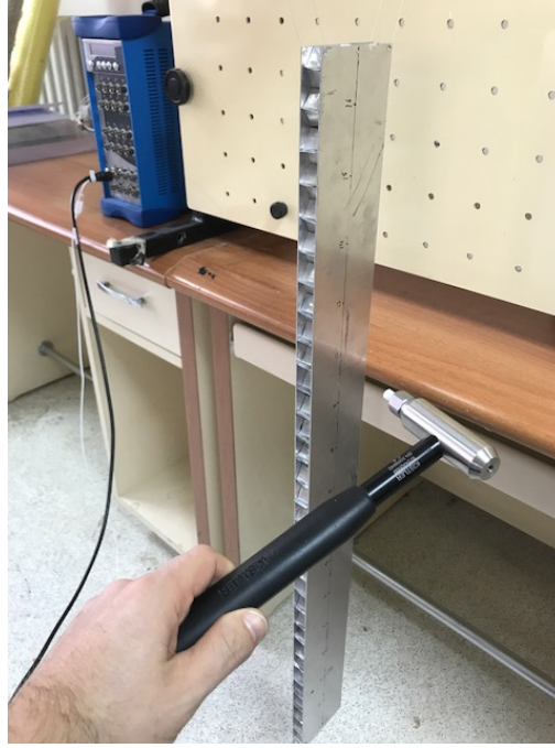
Şekil 8.5 Deneysel çalışma için asılan büyük hücreli bal peteği yapı (S-S sınır şartları)
