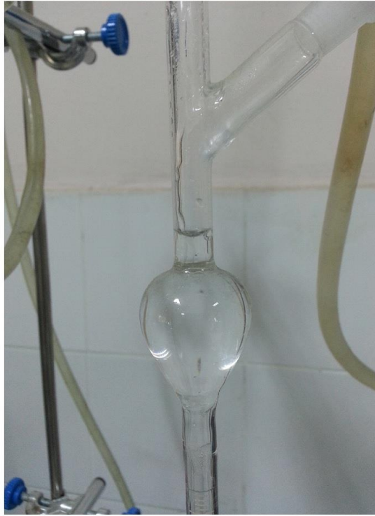
Şekil 9 Citrus medica Meyve Kabuklarından Su Distilasyon ile Uçucu Yağ Eldesi
