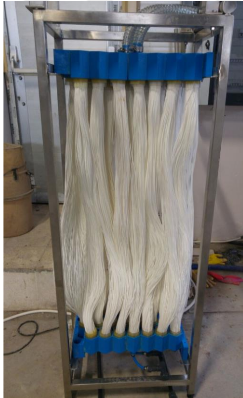
Şekil 2.4. MBR'de kullanılan membran modülü
