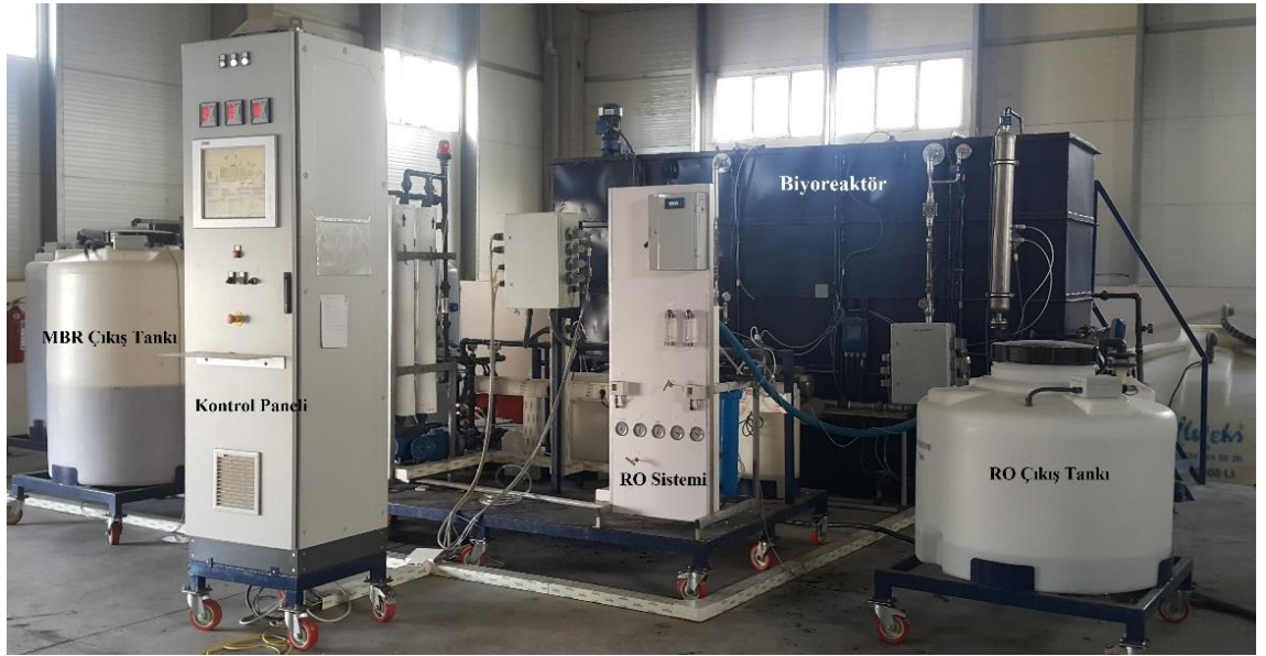
Şekil 2.1. Pilot ölçekli MBR ve RO sistemi görüntüsü
