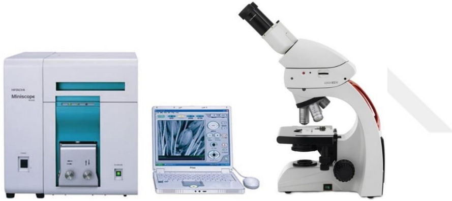
Şekil 6.4 : Hitachi TM – 1000 taramalı elektron mikroskobu ve Leica ICC50 HD optik mikroskobu.
