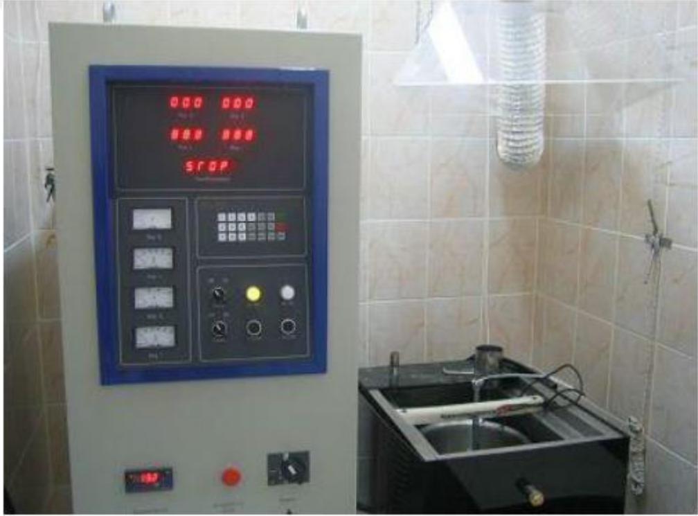
Şekil 6.3 : Mikro ark oksidasyon cihazı
