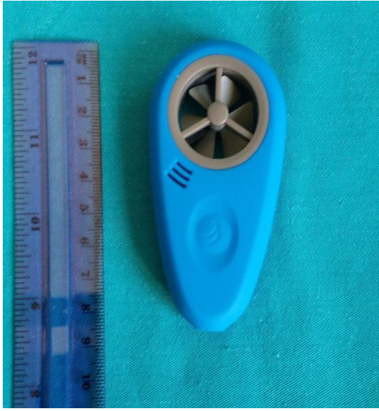
Resim-1. Kapalı su altı drenaj sisteminden drene olan havanın ölçümünde kullanılan anemometre. Cihaz küçük boyutları sayesinde mobil olarak kullanılabilir ve pil ile çalışmaktadır. Ölçüm işlemi için android işlemcili cep telefonlarına “bluetooth” ile bağlanabilir.
