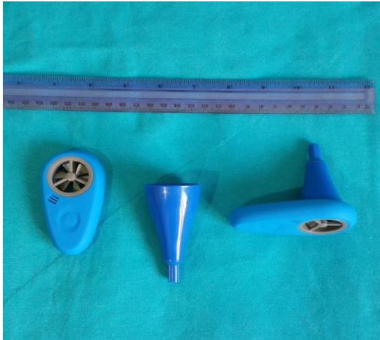
Resim-3 ve Resim-4. Anemometrenin toraks dreni hunisi ile entegre edilerek kapalı su altı drenaj sistemine uygun hale getirilişi gösterilmektedir.
