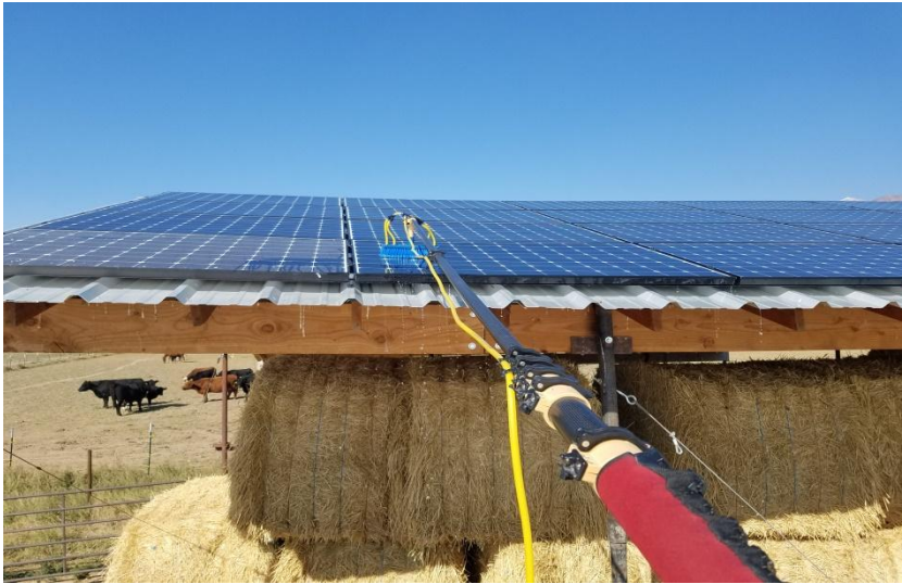
Şekil 4.3. Otomatik güneş paneli temizleme cihazı [59].
