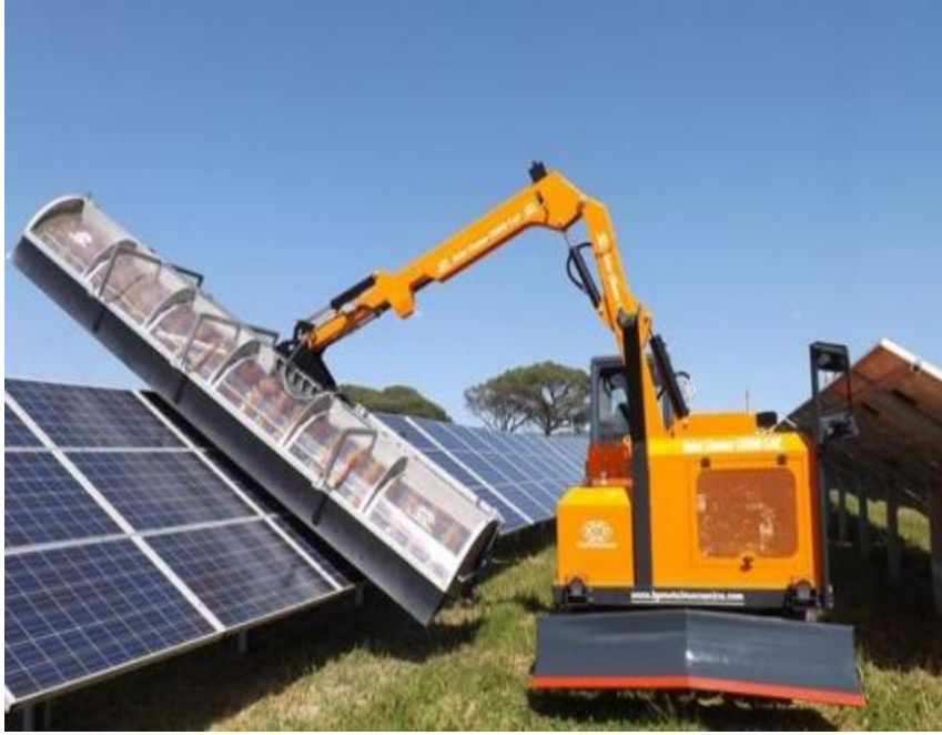
Şekil 4.6. Panel temizleme aracı [66].
