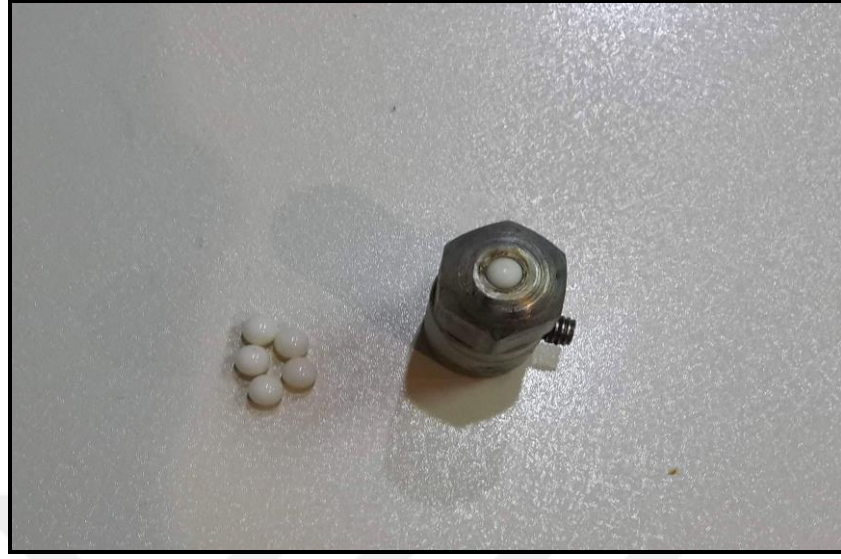
Şekil 3.8. Karşı malzeme (antagonist) olarak kullanılan 6 mm çapında seramik bilyenin (steatite balls) gösterimi
