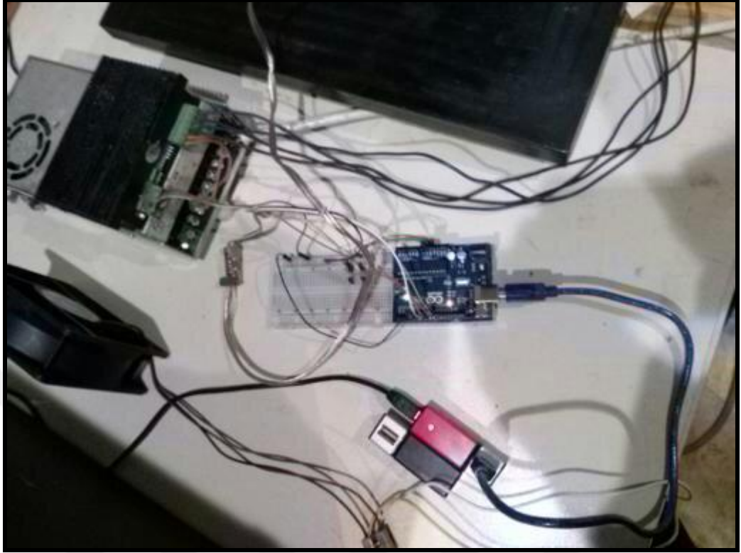
Şekil 3.22. Yatay hareket kontrol devresi ve step motor sürücü kartının gösterimi
