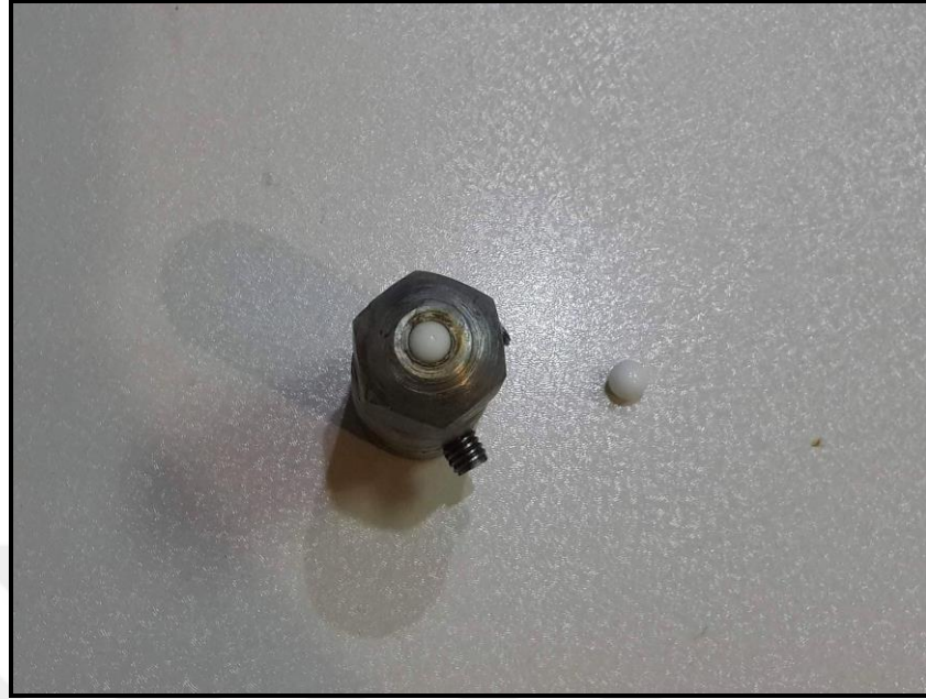
Şekil 3.5. Karşı malzeme (antagonist) olarak kullanılan 6 mm çapındaki Al_2O_3 bilyenin gösterimi
