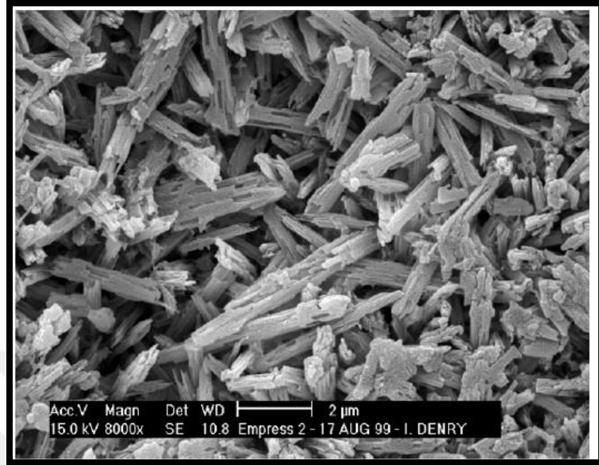
Şekil 2.12. Isı ile preslenmiş lityum disilikat seramik malzemesinin mikro içyapısı (Denry and Holloway 2010)
