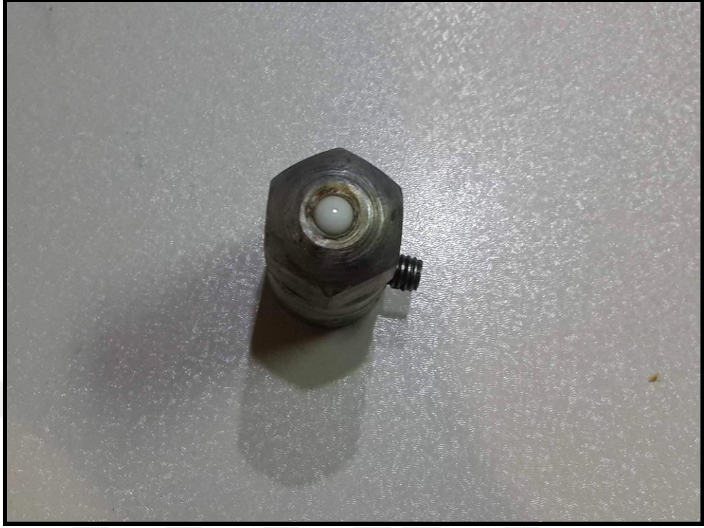
Şekil 3.11. Seramik malzemelerin çığneme testinde karşı malzeme (antagonist) olarak kullanılan 6 mm çapındaki Al_2O_3 bilyenin gösterimi
