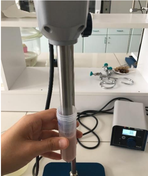
Şekil 2.5. Ham ve olgun F.carica meyvelerinin homojenizatörle ekstraksiyonu.
