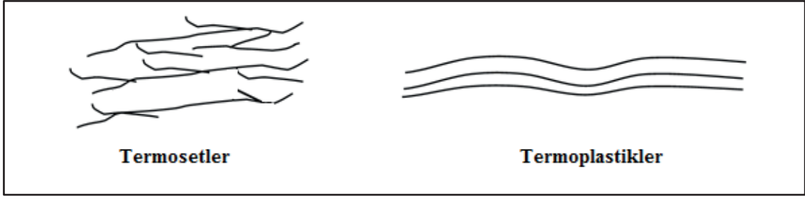
Şekil 2.3: Termoset ve termoplastik polimerlerin yapıları.
