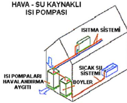
Şekil 2.9. Hava-Su kaynaklı ısı pompası (Yamankaradeniz 2007).
