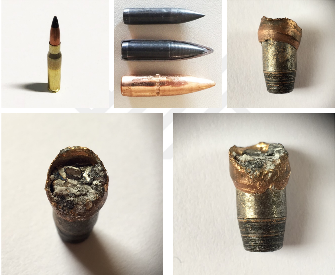
Resim 4.2. 7.62mm x51 zırh delici mermi ve atış sonrası kırılan mermi çekirdeği
