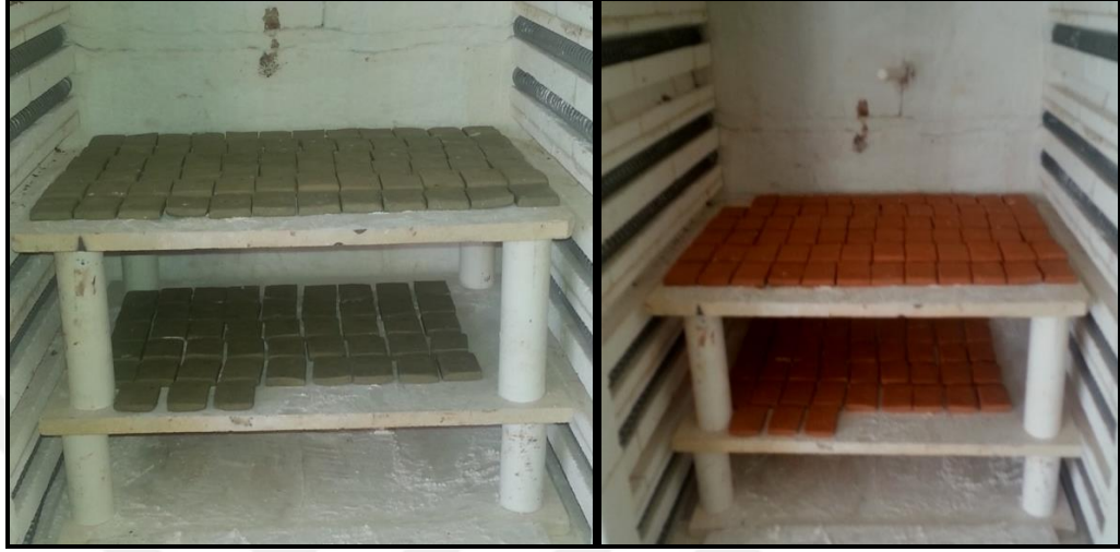
Şekil 3. 1 Pişmemiş (soldaki) ve pişmiş (sağdaki) tuğla örnekleri (Kişisel arşiv, 2017)
