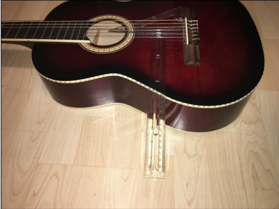
Şekil 3.1: Gitar gövde kapağının kenar mesafelerinin ölçümü
