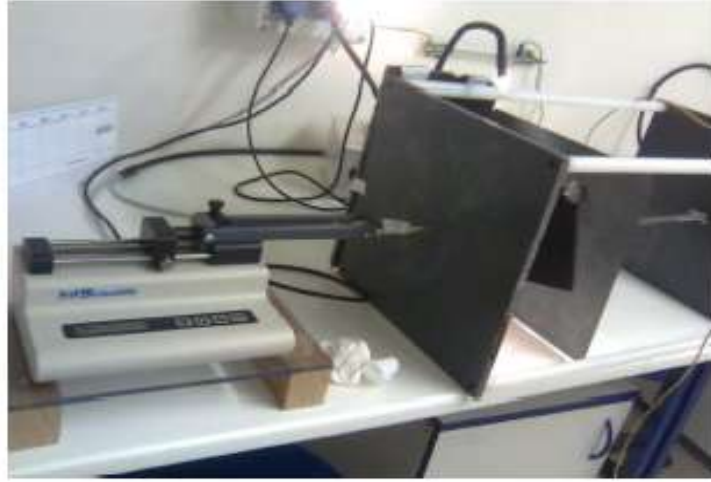
Şekil 3.8. Deneylerde kullanılan iğneli elektro lif çekim sistemi
