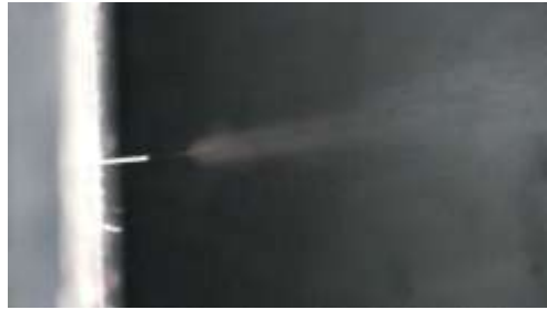
Şekil 4.16. Sabit sprej yapısı
