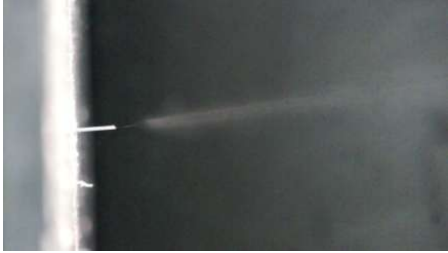
Şekil 3.12. İğneli elektro lif çekim yönteminde PU polimer çözeltisinden lif çekimi
