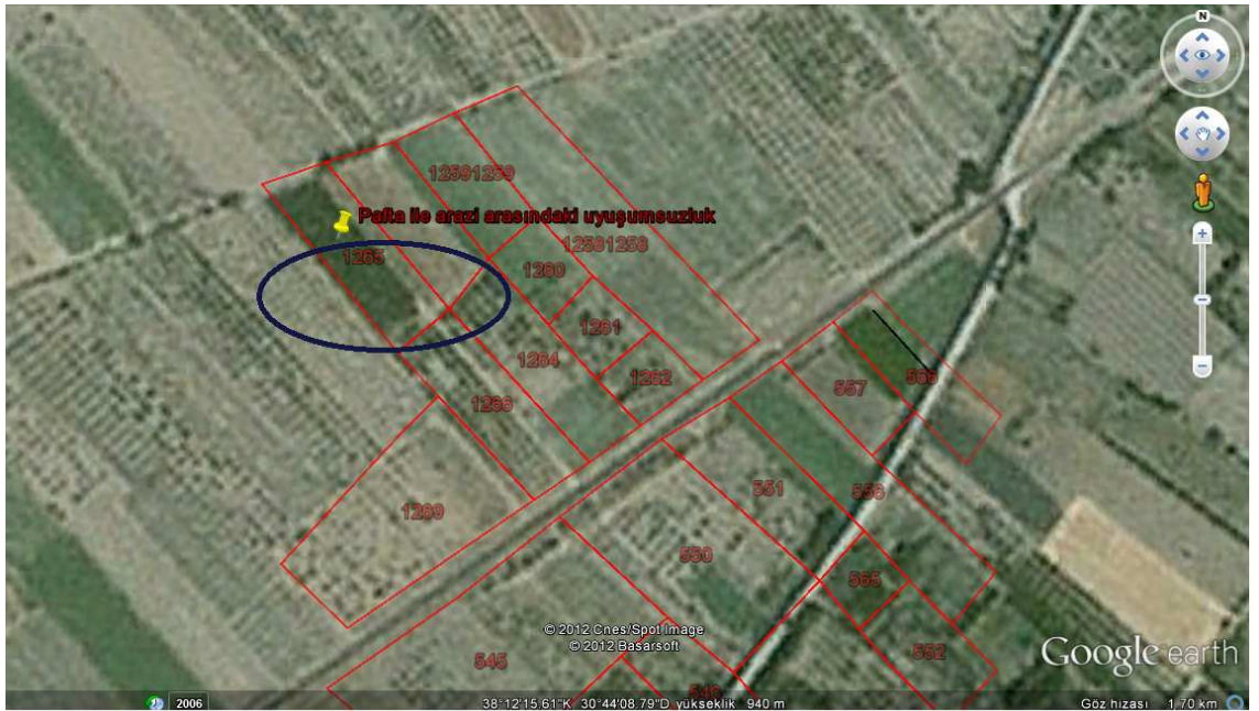
Şekil 4.12. Grafik pafta ile uydu görüntüsü arasındaki uyumsuzluk
