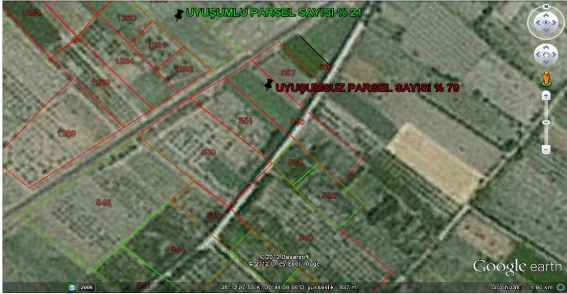
Şekil 4.15. Pilot çalışma alanındaki grafik kadastro parselleri ile uydu görüntüsü durumu
