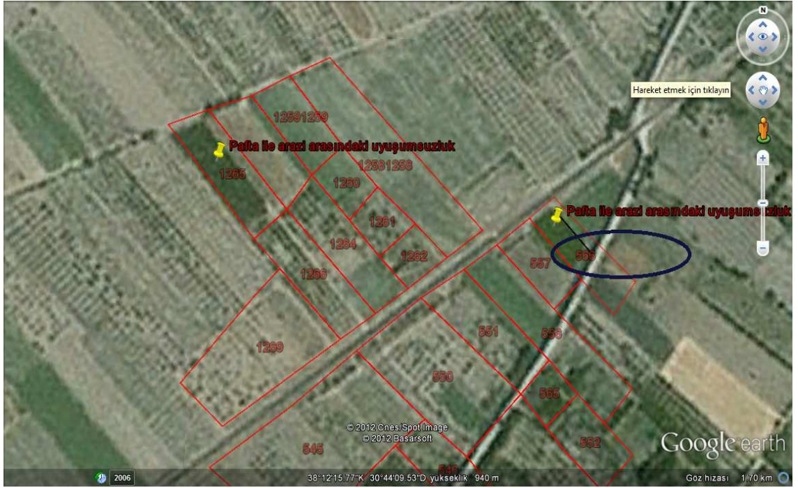
Şekil 4.11. Grafik pafta ile uydu görüntüsü arasındaki uyumsuzluk
