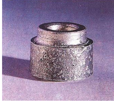
Şekil 4. 3 : Sinterleme ile üretilmiş elmas boncuk.
