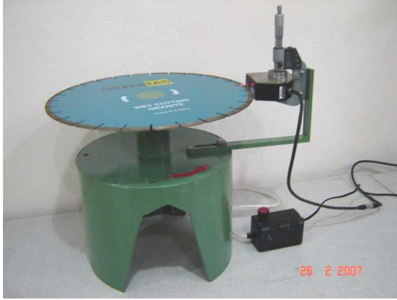
Şekil 7.11 : Disk etrafındaki aşınmayı ölçmek için tasarlanmış deney düzeneği [38].
