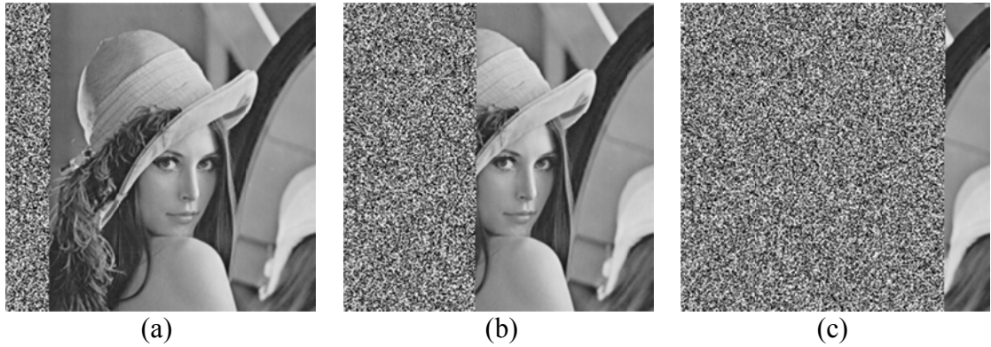
Şekil 4.8. Sistem başlar başlamaz yapılacak şifrelemede a) 0.03 saniye, b) 0.05 saniye, c) 0.09 saniye sonraki çıkış görüntüleri.
