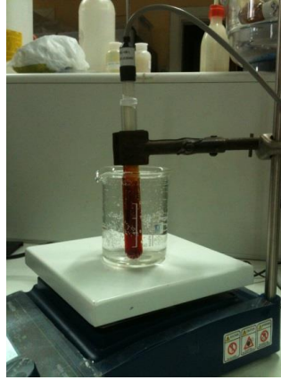
Şekil 3.6: Polimer jel elektrolitlerin iletkenlik değerlerinin sıcaklık değişimi ile incelenmesi.
