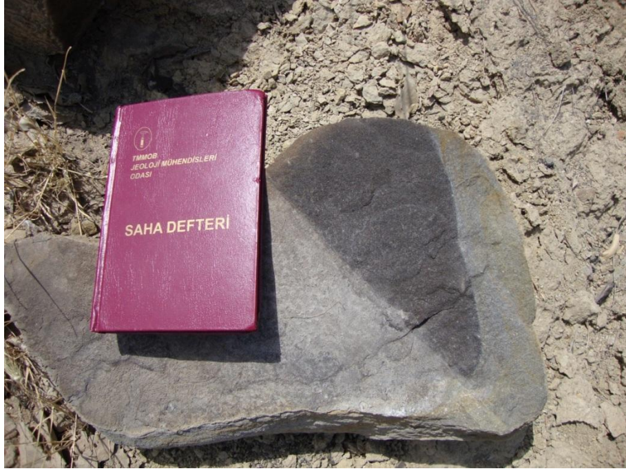
Şekil 2.7 Asfalt emareli Hazro kumtaşı örneği Diyarbakır/Hazro
