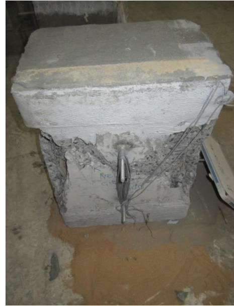
Şekil A.15: R-112.5-8-NC-S100 numunesinin göçme modü resimleri
