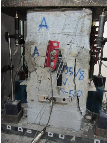
Şekil A.7: S-135-8-N-S50 numunesinin göçme modu resimleri
