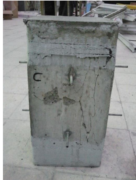
Şekil A.1: S-Ref numunesinin göçme modu resimleri
