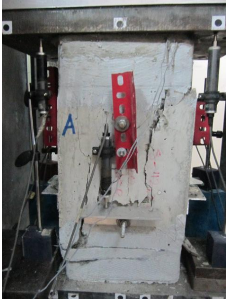
Şekil A.5: S-112.5-8-N-S50 numunesinin göçme modü resimleri
