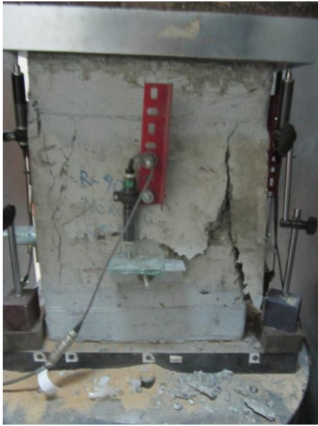
Şekil A.11: R-90-8-NC-S100 numunesinin göçme modü resimleri
