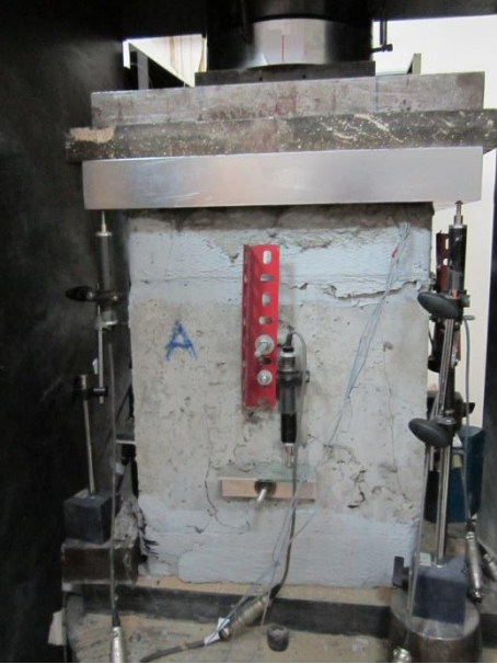
Şekil A.18: R-135-8-NC-S50 numunesinin göçme modü resimleri
