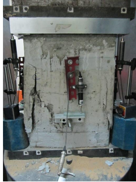
Şekil A.10: R-90-8-NC-S50 numunesinin göçme modü resimleri
