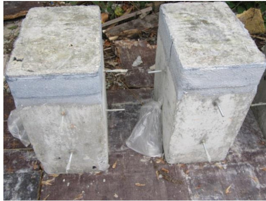
Şekil 4.23: Üst kısımları sargılanmış betonarme dikdörtgen numuneler.
