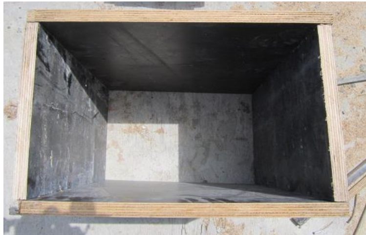
Şekil 4.13: Dikdörtgen numuneler için hazırlanan kalıplar
