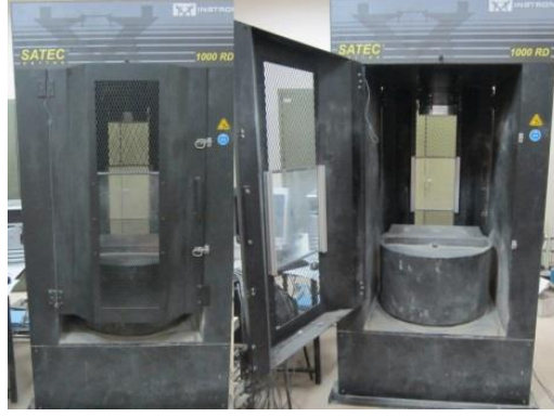
Şekil 4.32: 500 ton kapasiteli Instron test cihazı
