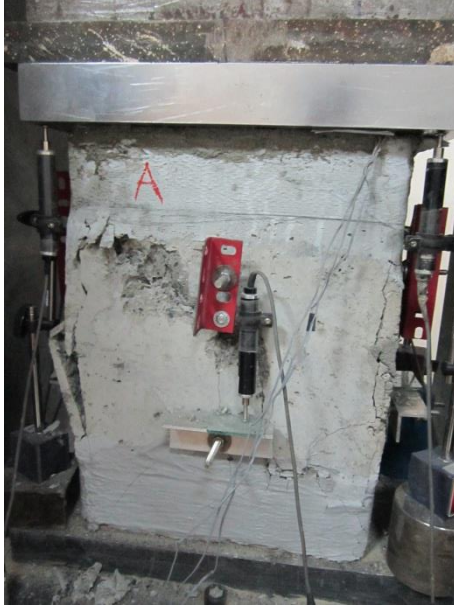
Şekil A.17: R-135-4-NC-S100 numunesinin göçme modu resimleri
