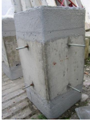
Şekil 4.22: Karbon kumaşla 2 kat sarılan betonarme kare numuneler
