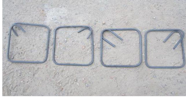
Şekil 4.5: Kare etriyelerde kanca biçimleri
