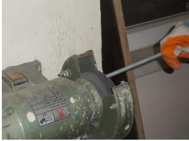
Şekil 4.16: Tijlerin kalıplara yerleştirilmeden önce spiralde hazırlanması
