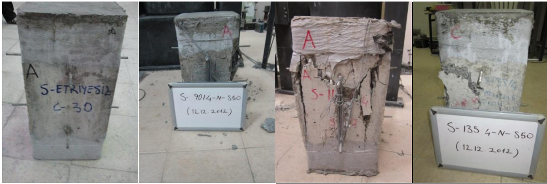
Şekil 5.4: Sırasıyla S-Ref, S-90-4-N-S50, S-112.5-4-N-S50, S-135-4-N-S50 numunelerinin deney sonrası görünüşleri
