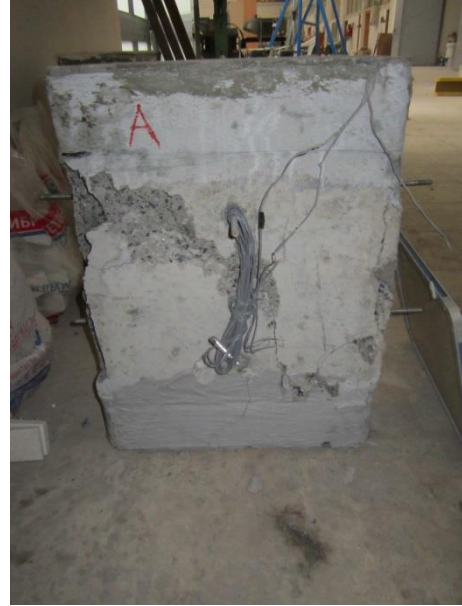
Şekil A.17: R-135-4-NC-S100 numunesinin göçme modu resimleri
