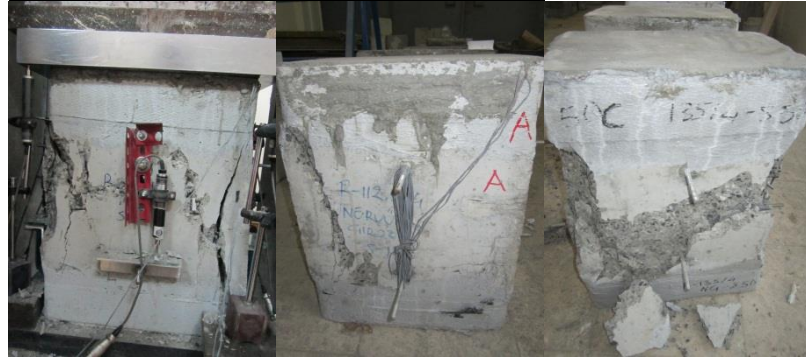
Şekil 5.8: Sırasıyla R-90-4-NC-S50, R-112.5-4-NC-S50, R-135-4-NC-S50 deney sonrası görünüşleri
