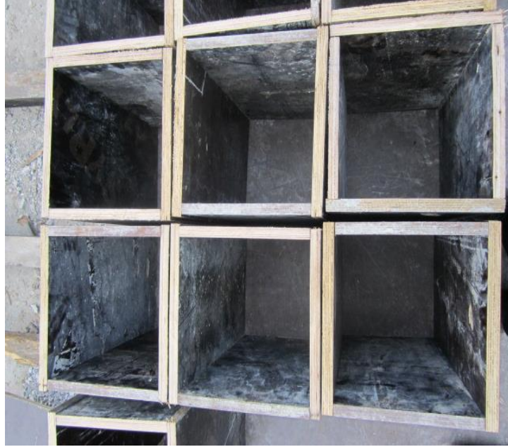
Şekil 4.12: Kare numuneler için hazırlanan kalıplar
