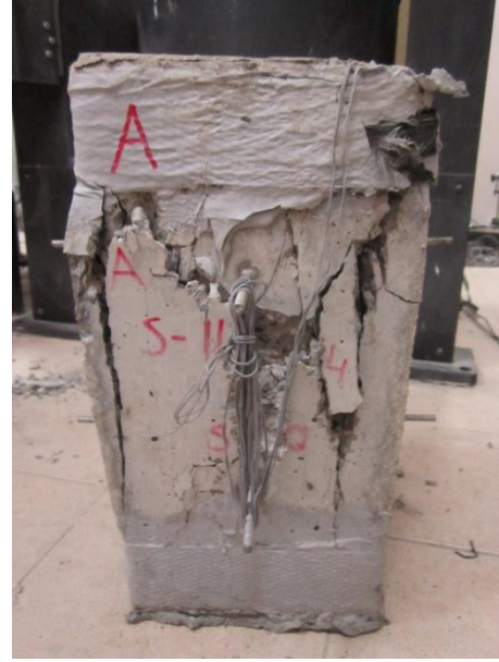
Şekil A.4: S-112.5-4-N-S50 numunesinin göçme modu resimleri
