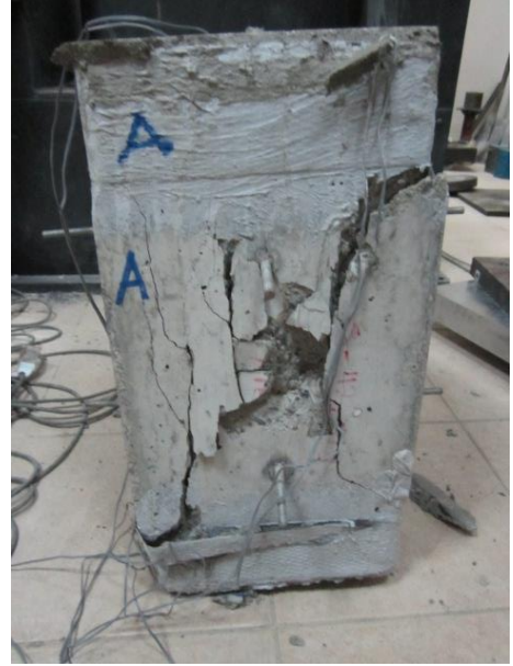
Şekil A.5: S-112.5-8-N-S50 numunesinin göçme modü resimleri
