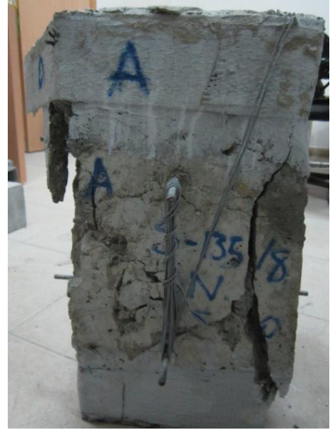
Şekil A.7: S-135-8-N-S50 numunesinin göçme modu resimleri
