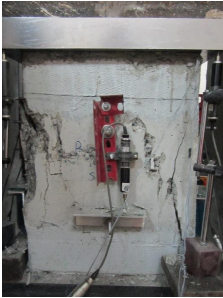
Şekil A.8: R-90-4-NC-S50 numunesinin göçme modu resimleri
