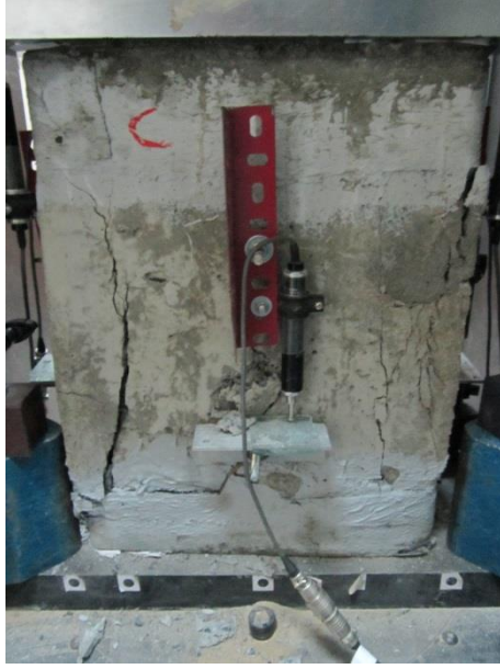
Şekil A.9: R-90-4-NC-S100 numunesinin göçme modü resimleri
