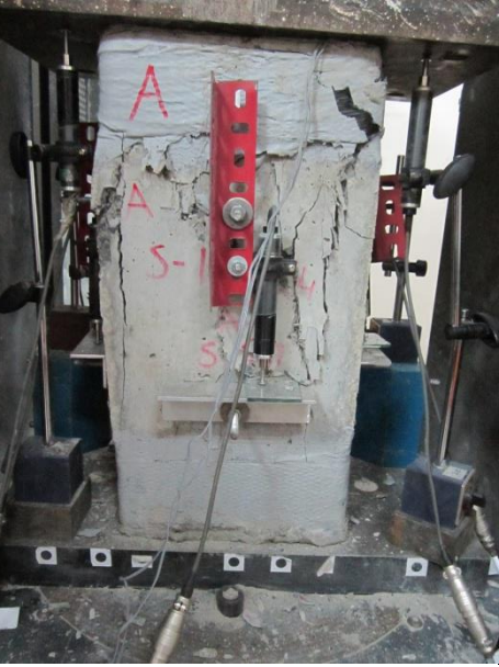
Şekil A.4: S-112.5-4-N-S50 numunesinin göçme modu resimleri
