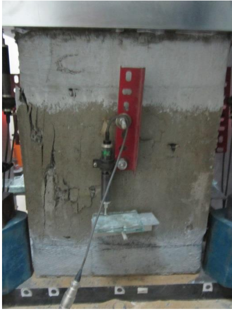
Şekil A.19: R-135-8-NC-S100 numunesinin göçme modü resimleri
