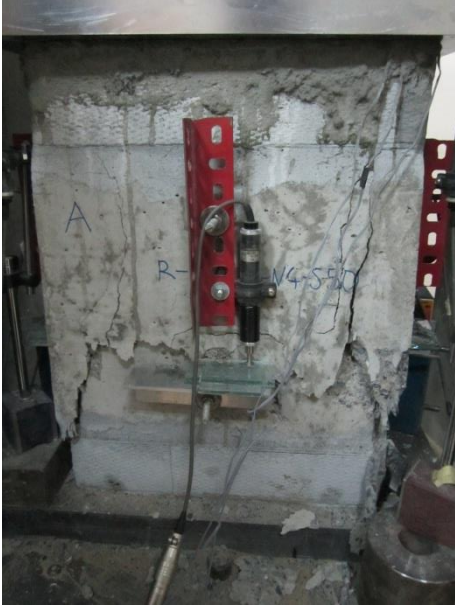
Şekil A.10: R-90-8-NC-S50 numunesinin göçme modü resimleri
