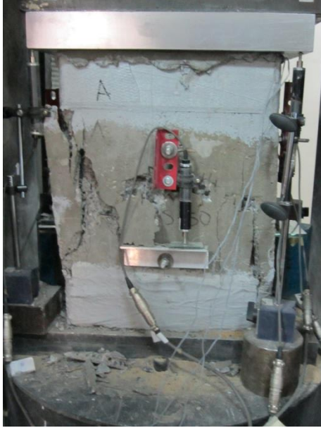
Şekil A.16: R-135-4-NC-S50 numunesinin göçme modü resimleri
