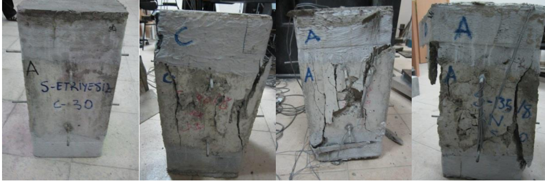
Şekil 5.6: Sırasıyla S-Ref, S-90-8-N-S50, S-112.5-8-N-S50, S-135-8-N-S50 deney sonrası görünüşleri
