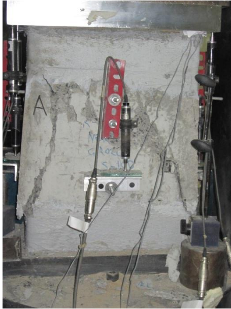
Şekil A.15: R-112.5-8-NC-S100 numunesinin göçme modü resimleri
