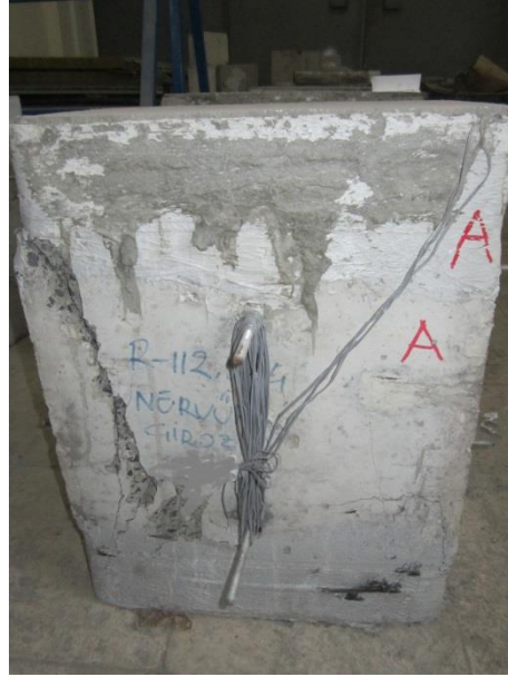
Şekil A.12: R-112.5-4-NC-S50 numunesinin göçme modü resimleri
