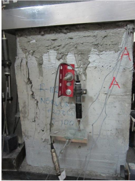
Şekil A.13: R-112.5-4-NC-S100 numunesinin göçme modu resimleri
