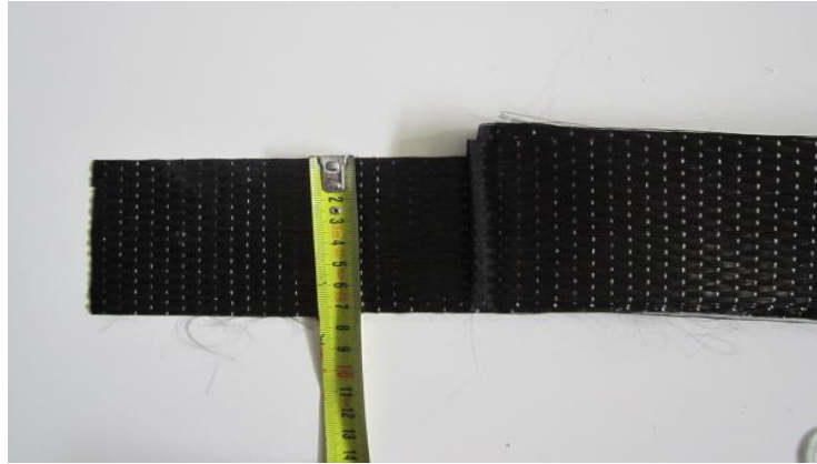
Şekil 4.21: 7,5 cm boyunda kesilen karbon kumaş
