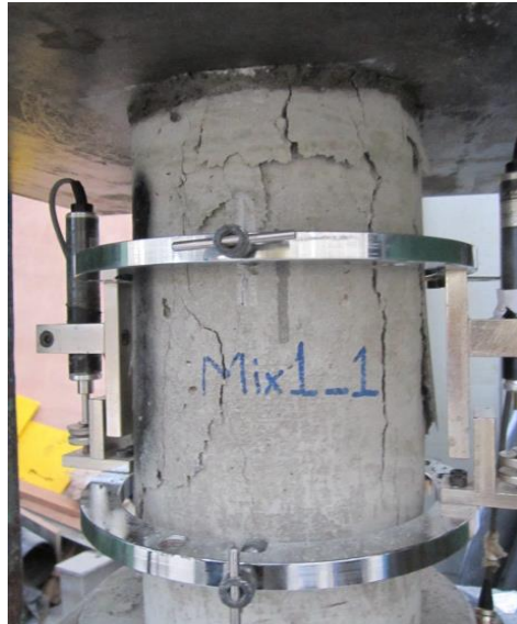
Şekil 4.2: 28 Günlük karışım1-1 silindir numunesinin test edilmesi
