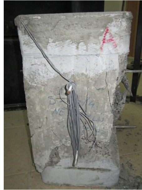
Şekil A.2: S-90-4-N-S50 numunesinin göçme modü resimleri
