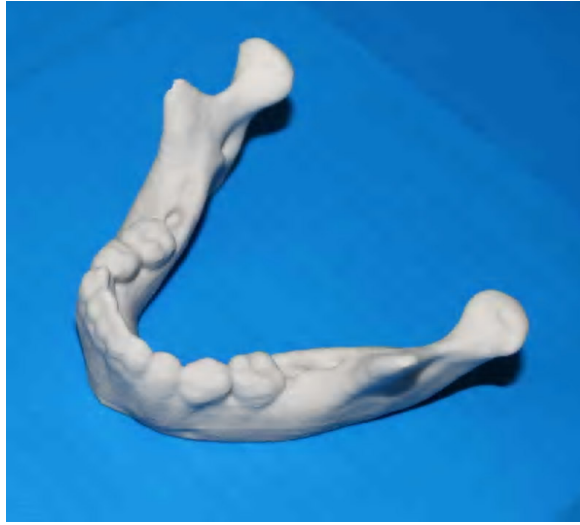
Şekil 2.11. Bilgisayarda işlenen görüntünün hızlı prototiplenmiş hali
