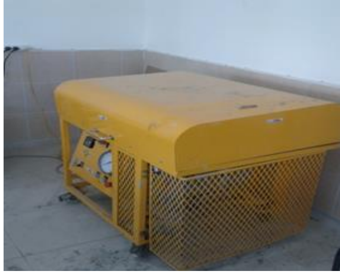
Şekil 3.12. İki nokta işlenebilirlik deney cihazının (CTPT) genel görünüşü.
