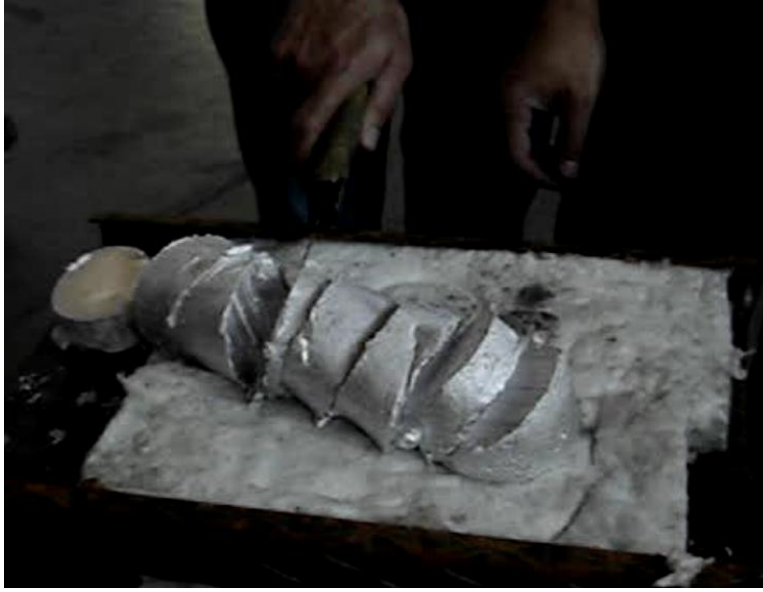
Resim 2.1. Yarı-katı haldeki Etial-61 alaşımının bıçak ile kesilmesi
