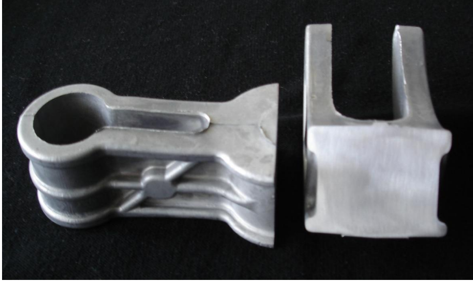
Resim 6.10. Reo yarı-katı döküm yöntemi ile üretilen sedye parçasında makroyapı
