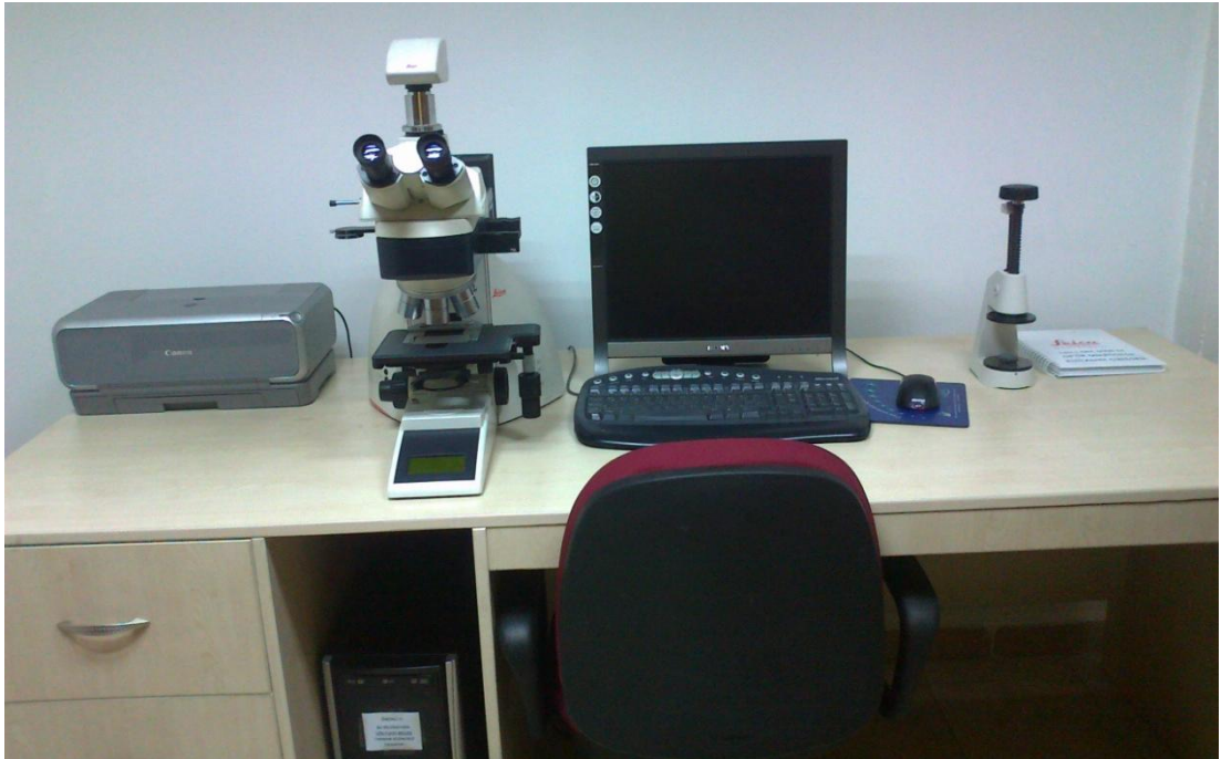
Resim 6.9. Mikroyapıların görüntülenmesinde kullanılan optik mikroskop
