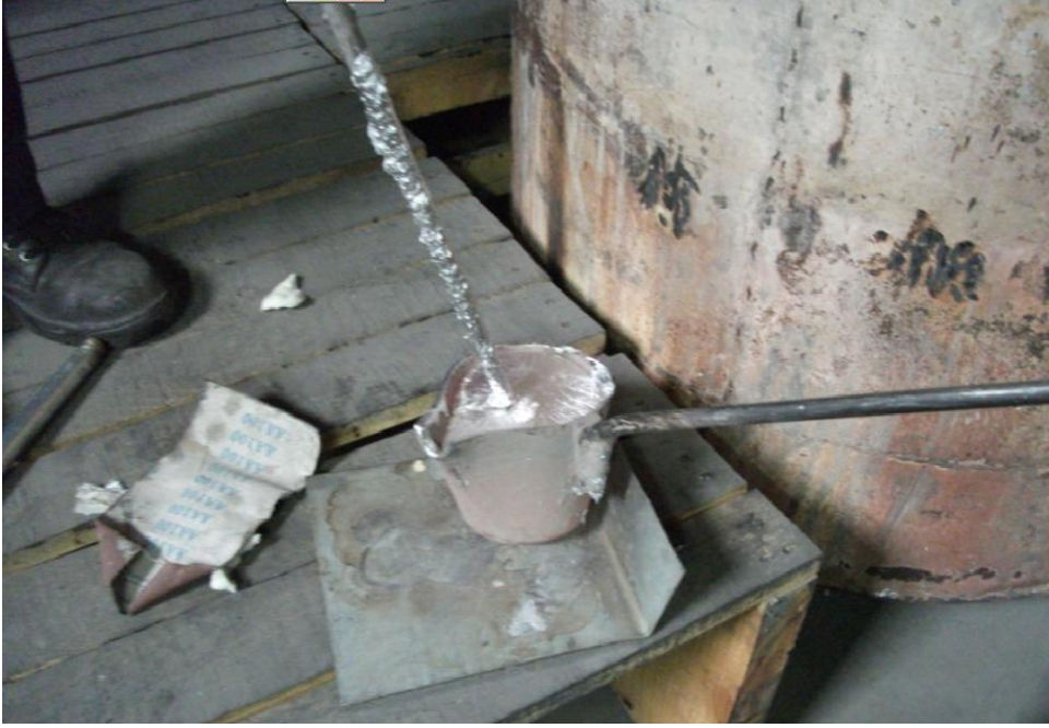
Resim 6.3. K tipi termokupl ile yapılan sıcaklık kontrolü
