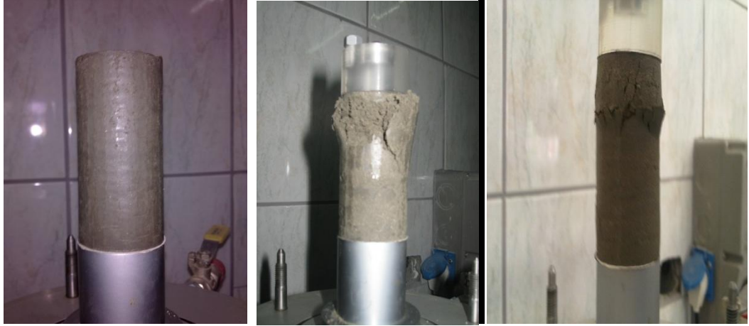
Şekil 4.4 Yüksek plastisiteli kil zeminin serbest basınç deneyi
