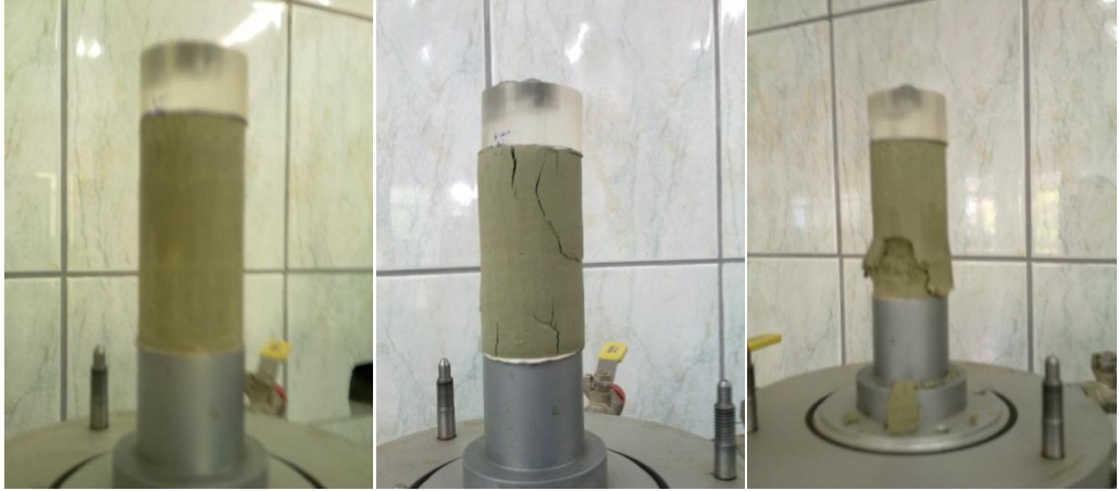
Şekil 4.3 Düşük plastisiteli kil zeminin serbest basınç deneyi
