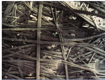
Şekil 2.10. Örgüsüz ısı olarak birleştirilmiş geotekstil mikrofilmi (GMA,2002)
