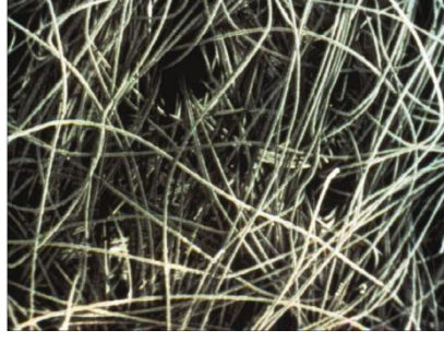
Şekil 2.9. Örgüsüz iğneleme ile birleştirilmiş geotekstil mikrofilmi (GMA,2002)
