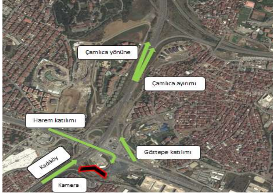
Şekil 3.3: Uzunçayır kavşağı'nda yerleştirilen kamera'nın yeri ve trafik akım yönleri.
