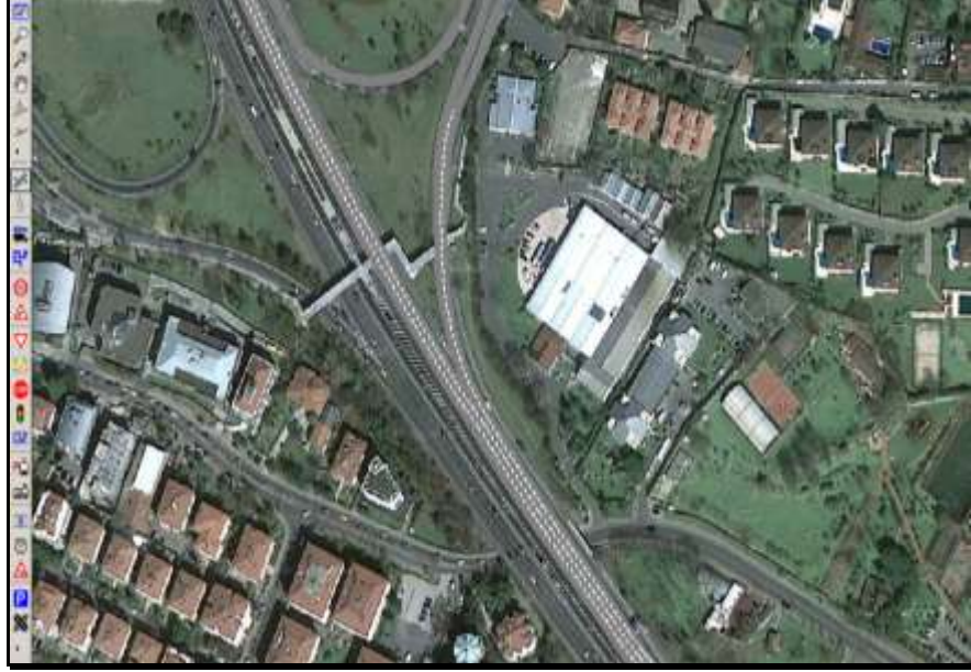
Şekil 3.20: Altunize ayrımının VISSIM Simülasyon ortamına aktarılmış hali.
