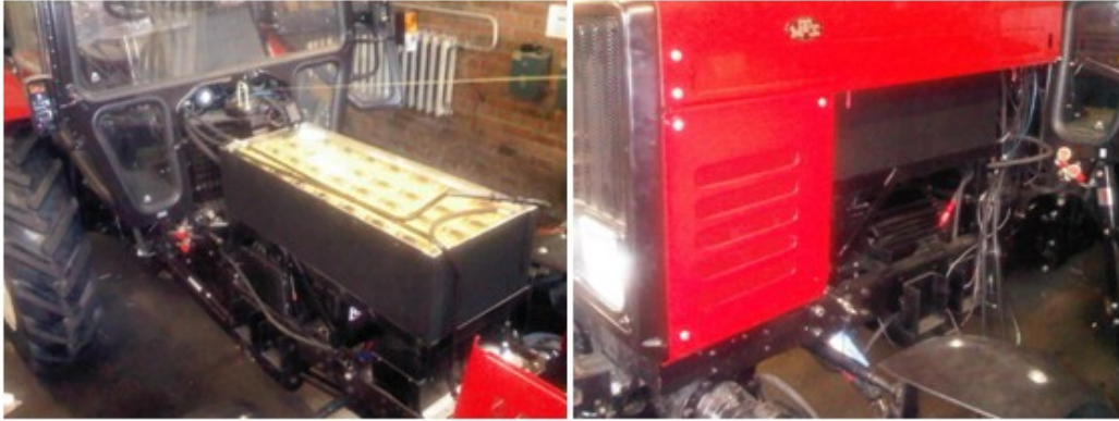
Şekil 6.6: Traktörlerde elektrikli motoru uygulaması.
