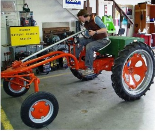
Şekil 6.2: G tipi traktörde elektrik motoru uygulaması.
