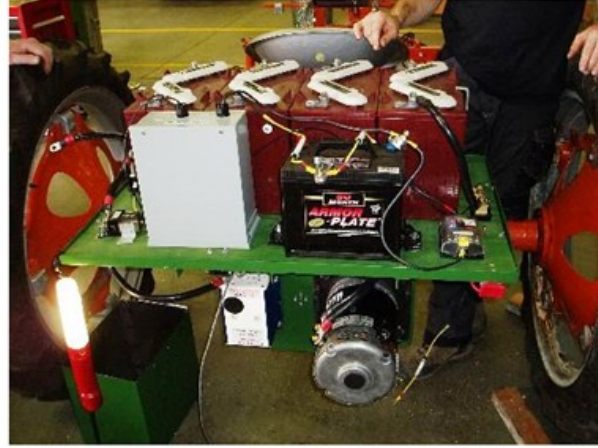
Şekil 6.2: G tipi traktörde elektrik motoru uygulaması.
