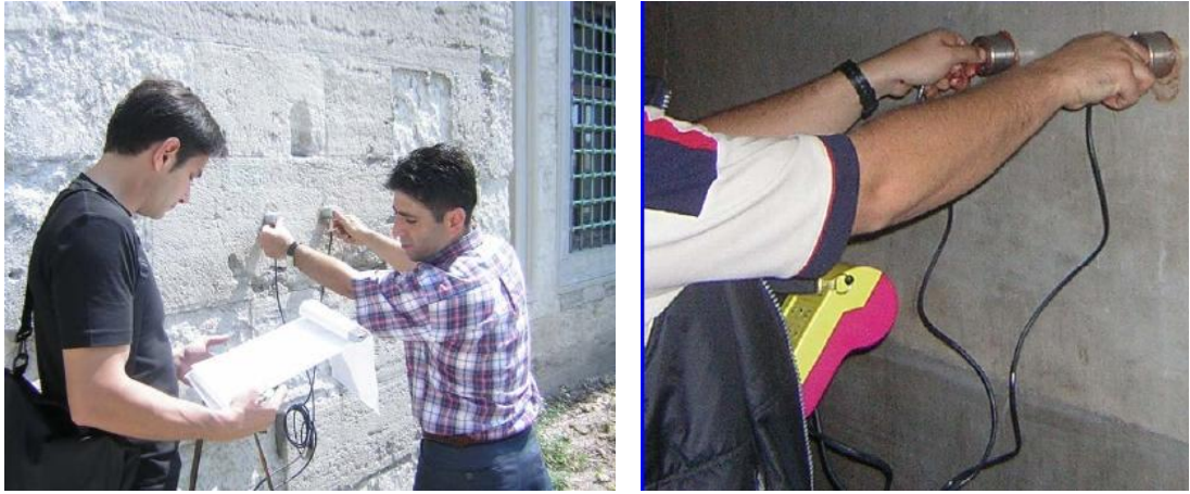
Resim 3.5. Ultrases aleti ile ses geçiş sürelerinin ölçülmesi [3]
