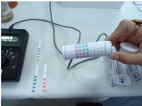
Resim 3.11. Spot tuz testlerinde örneklerin pH tespitlerinin yapılması, 2011 [34]
