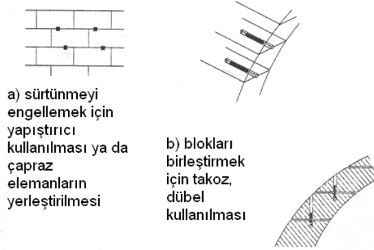
Şekil 4.6. Duvarlar ve kemerler arasındaki kesme kuvvetlerinin düzeltilmesi [17]
