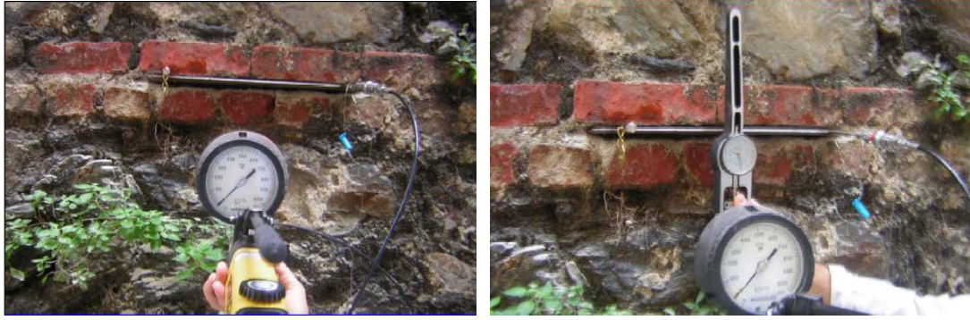
Resim 3.3. Yük altında basınç deneyi [3]
