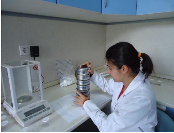
Resim 3.14. Harç ve sıva örneklerinin elekten geçirilip tartılması, 2011 [34]
