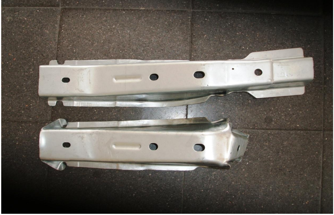
Resim 4.17. Orijinal şasi ile deformasyona uğramış şasinin dıştan görünümü
