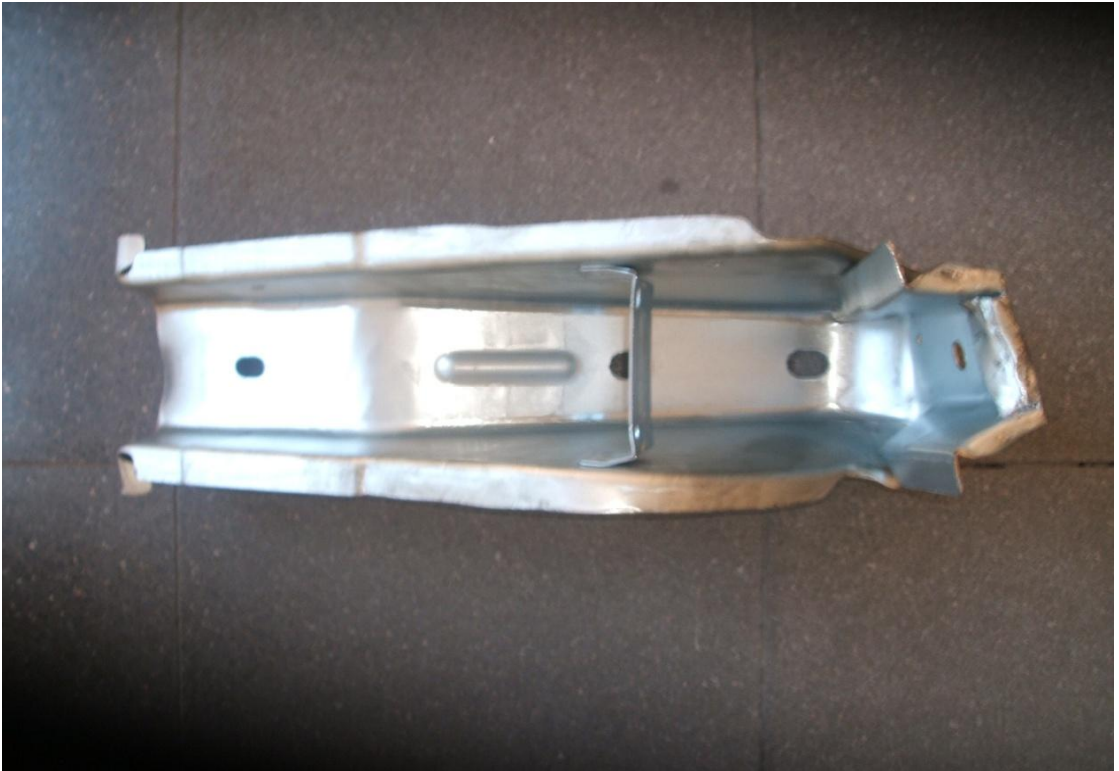
Resim 4.14. Deformasyona uğramış şasinin içten görünümü
