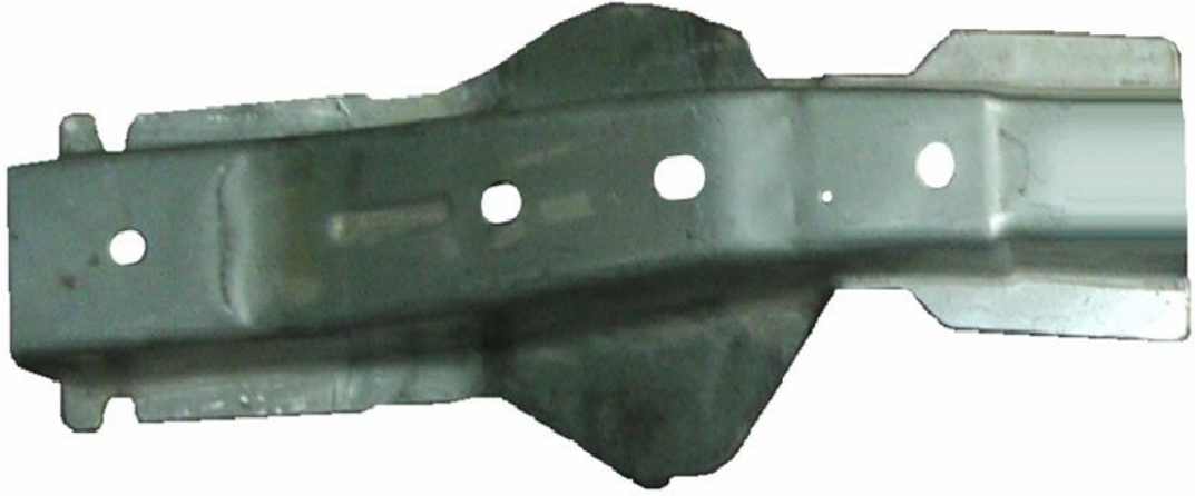
Resim 4.7. Çevre kesme+ delik delme yapılmış şasinin görünümü
