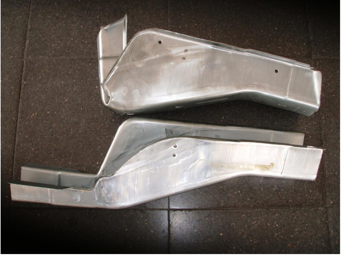
Resim 4.19. Orijinal şasi ile deformasyona uğramış şasinin yandan görünümü
