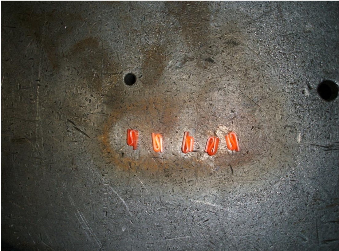
Resim 5.7. Çentik darbe testi için deformasyona uğramış sıcak olarak düzeltilen 5 adet numune
