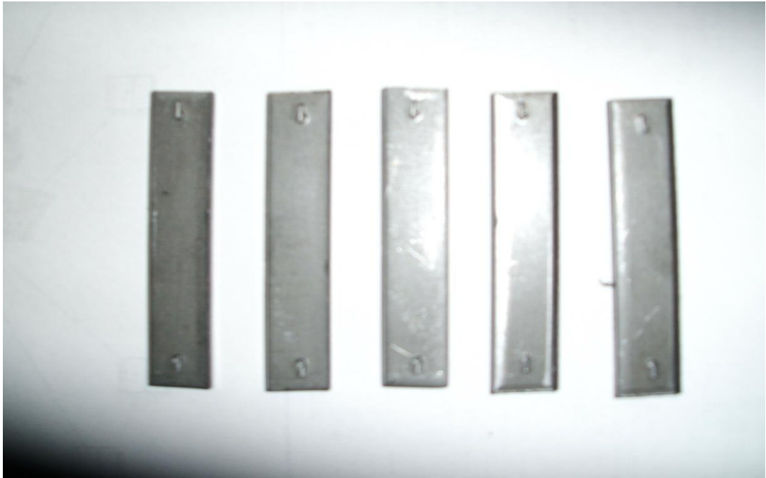
Resim 5.5. Çentik darbe testi için orijinal sacdan hazırlanan 5 adet numune
