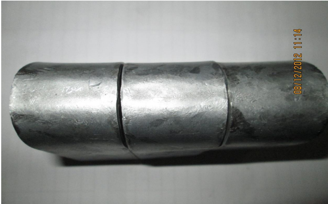
Resim 6.2. Deformasyona uğrayıp soğuk olarak düzeltilen sacın eğme testi sonucu görünümü
