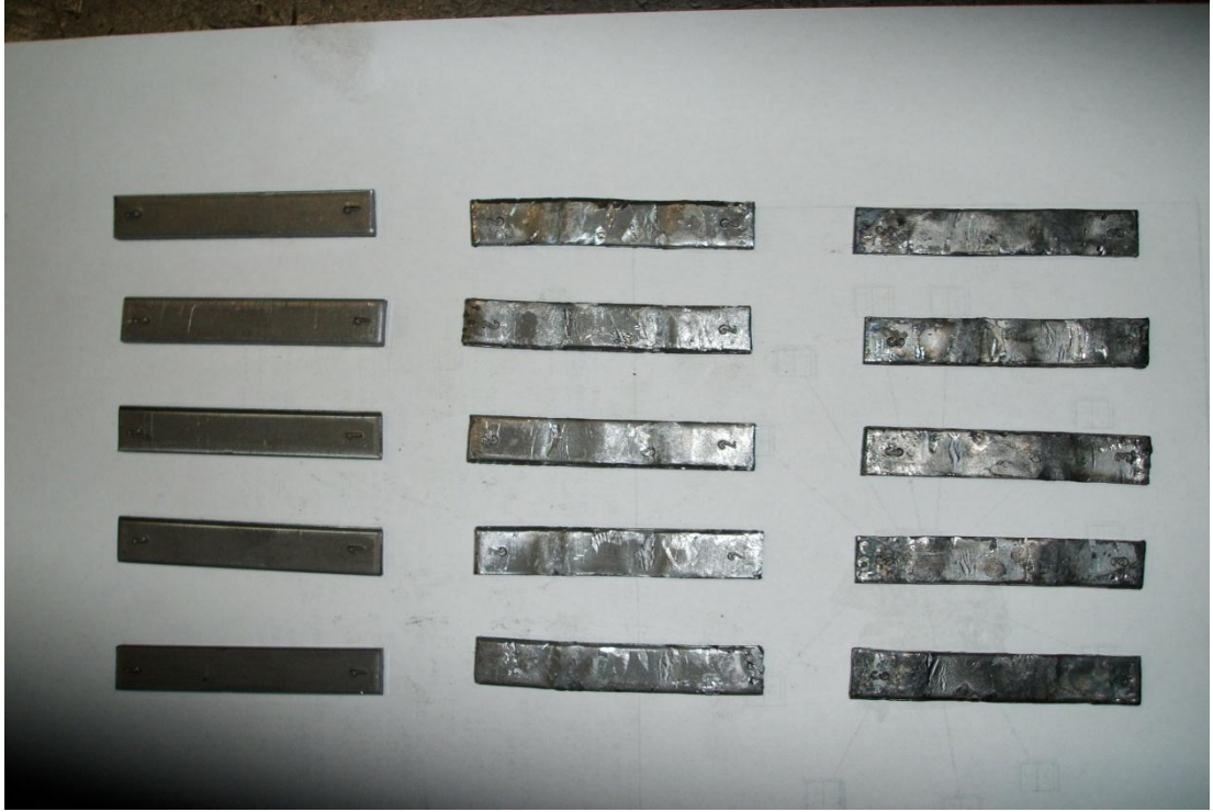
Resim 5.8. Çentik darbe testi için hazırlanan 5'er adet numunelerin düzeltilmiş hali
