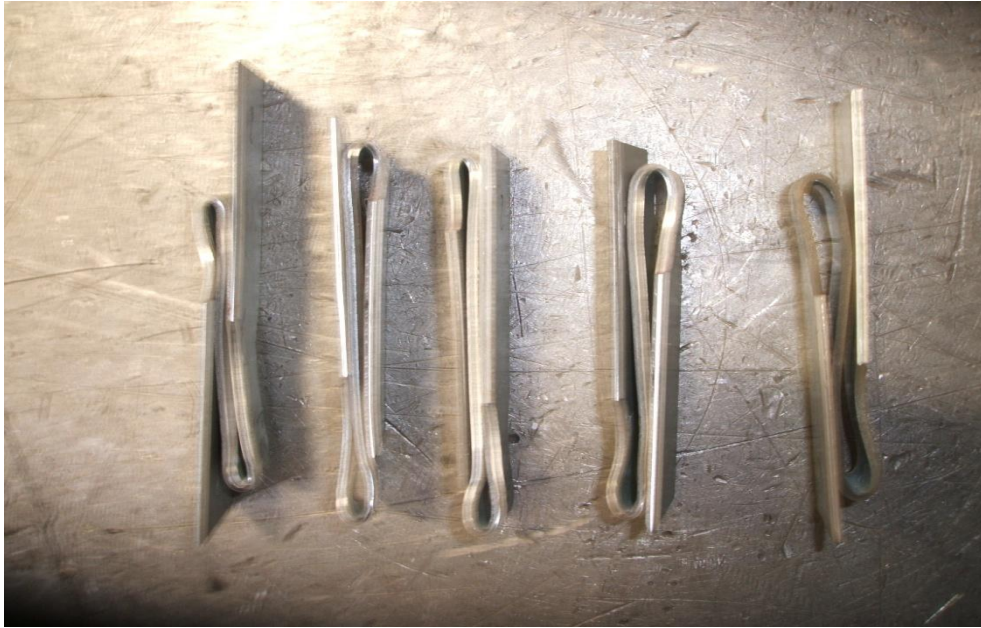
Resim 5.2. Deformasyona uğramış soğuk olarak düzeltilen sacdan hazırlanmış 5 adet çekme testi numunesi
