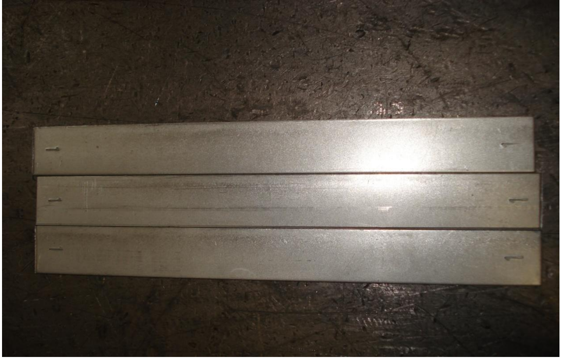
Resim 5.12. Sertlik testi için orijinal sacdan hazırlanan 3 adet numune
