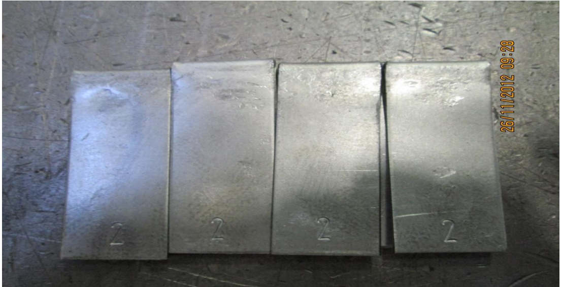
Resim 5.21. Deformasyona uğrayıp soğuk olarak düzeltilen sacdan eğme testi için numune hazırlanması
