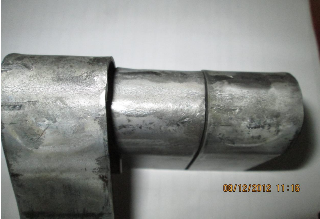
Resim 6.3. Deformasyona uğrayıp sıcak olarak düzeltilen sacın eğme testi sonucu görünümü
