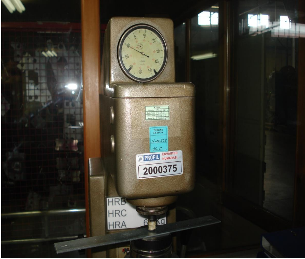
Resim 5.17. Orijinal sacın sertliğinin ölçülmesi
