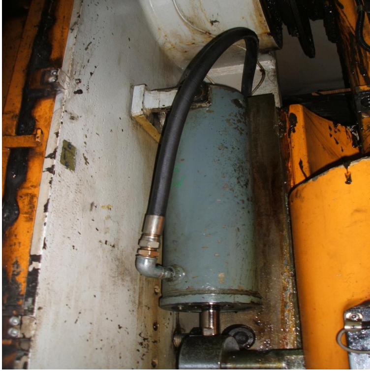
Resim 3.5. Eksantrik pres dengeleme silindiri
