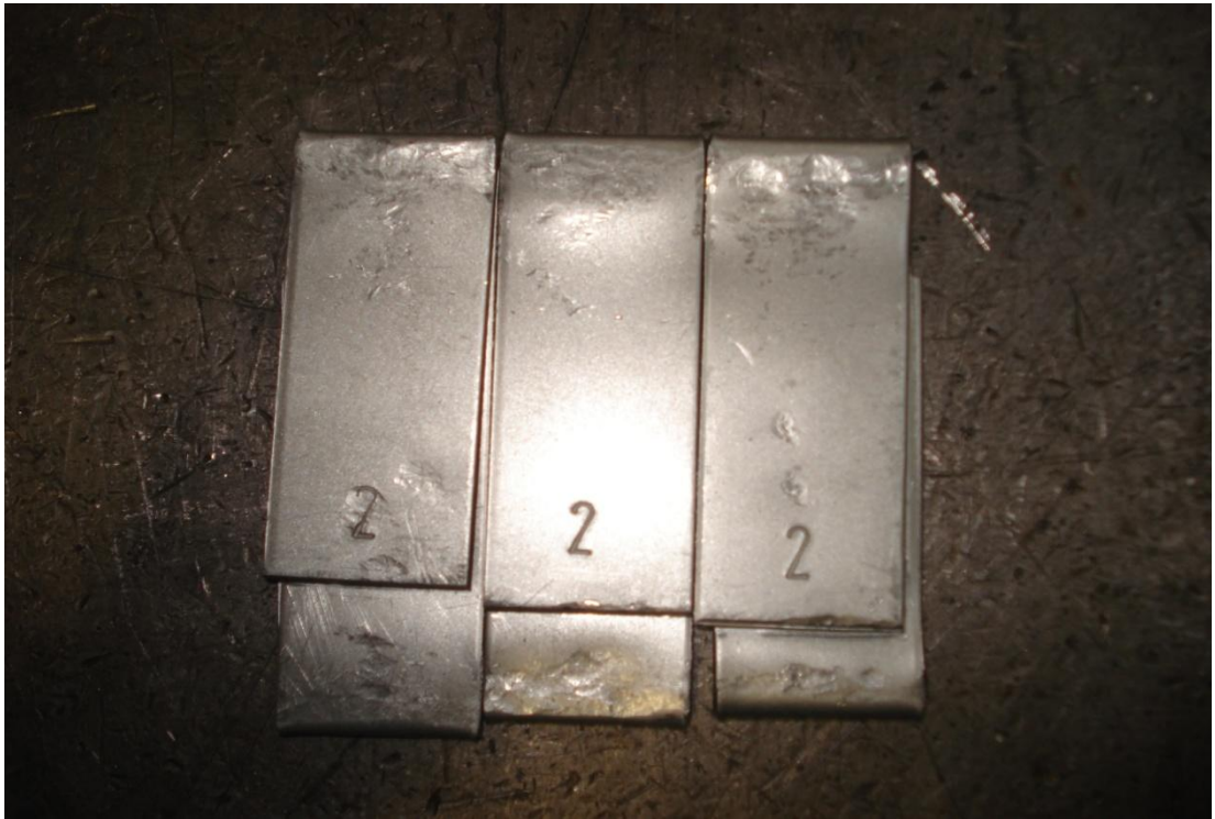
Resim 5.13. Sertlik testi için deformasyona uğrayan ve soğuk olarak düzeltilen 3 adet numune
