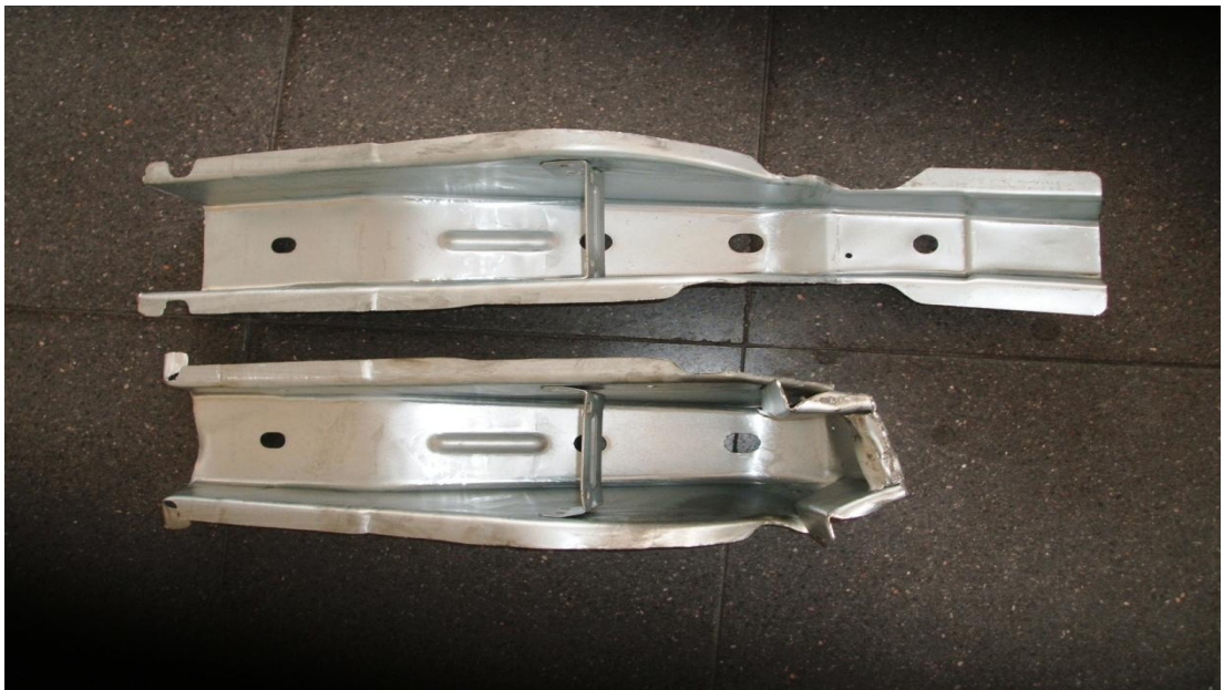
Resim 4.18. Orijinal şasi ile deformasyona uğramış şasinin içten görünümü
