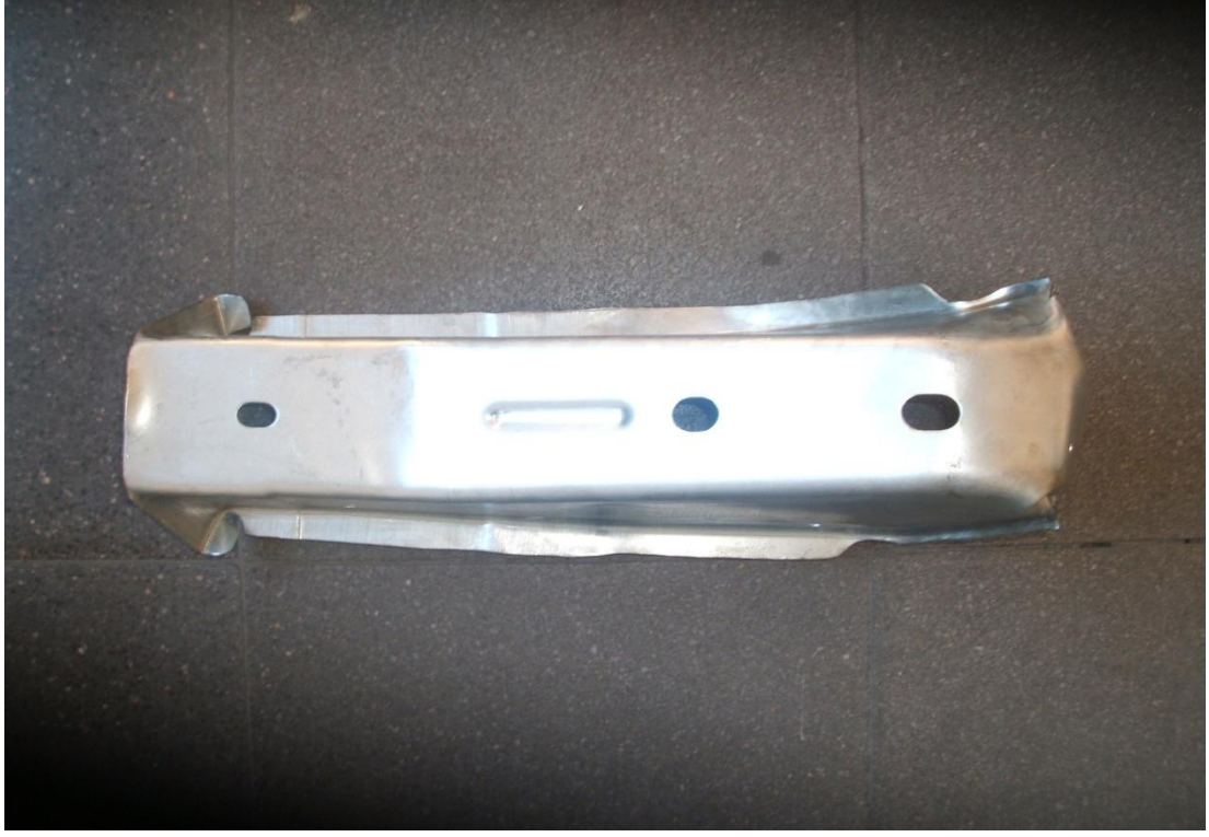
Resim 4.15. Deformasyona uğramış şasinin dıştan görünümü
