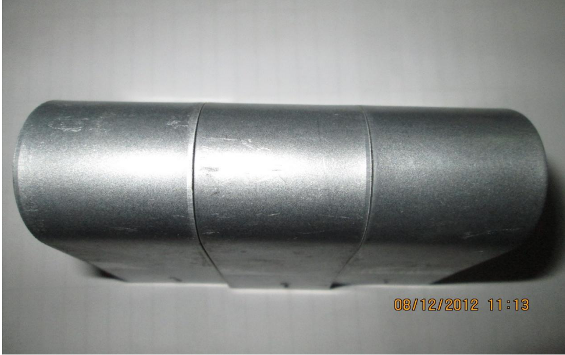
Resim 6.1. Orijinal sacların eğme testi sonucu
