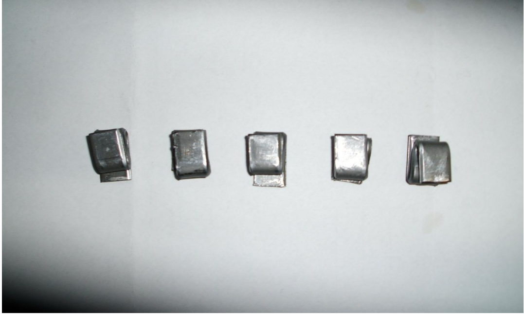
Resim 5.6. Çentik darbe testi için deformasyona uğramış soğuk olarak düzeltilen 5 adet numune
