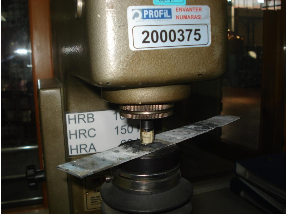
Resim 5.19. Deformasyona uğrayıp sıcak olarak düzeltilen sacın sertliğinin ölçülmesi
