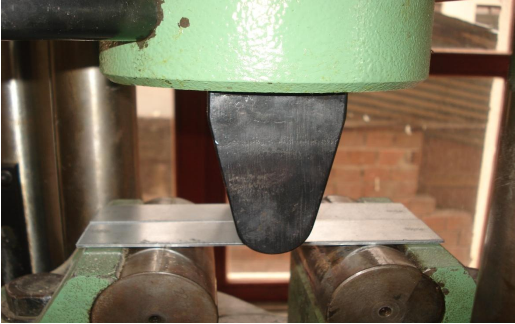
Resim 5.26. Hazırlanan numunelerin eğme testi yapılması
