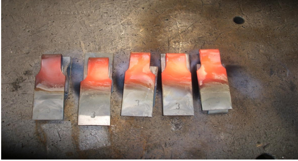
Resim 5.3. Deformasyona uğramış sıcak olarak düzeltilen sacdan hazırlanmış 5 adet çekme testi numunesi
