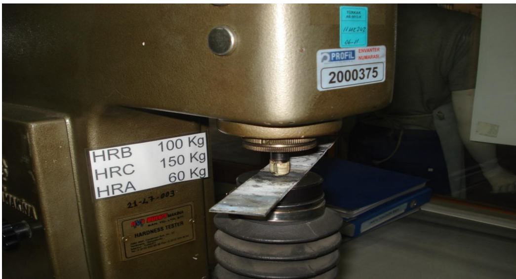
Resim 5.18. Deformasyona uğrayıp soğuk olarak düzeltilen sacın sertliğinin ölçülmesi
