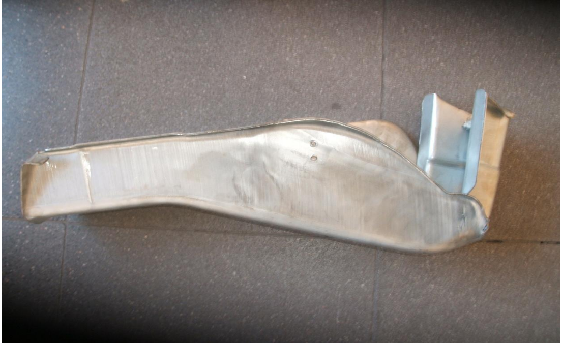
Resim 4.16. Deformasyona uğramış şasinin yandan görünümü
