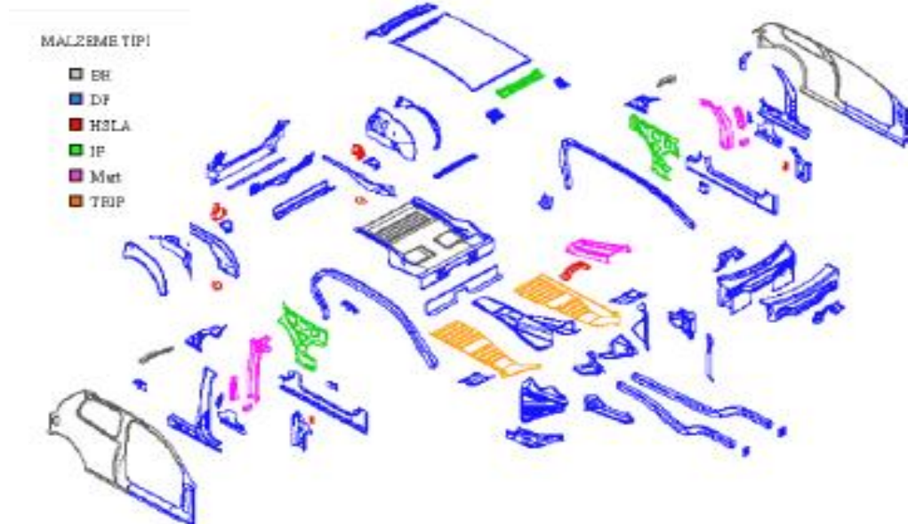
Şekil 4.9. Otomobillerde kullanılan gelişmiş çelik türlerinin kullanım yerleri [47].
