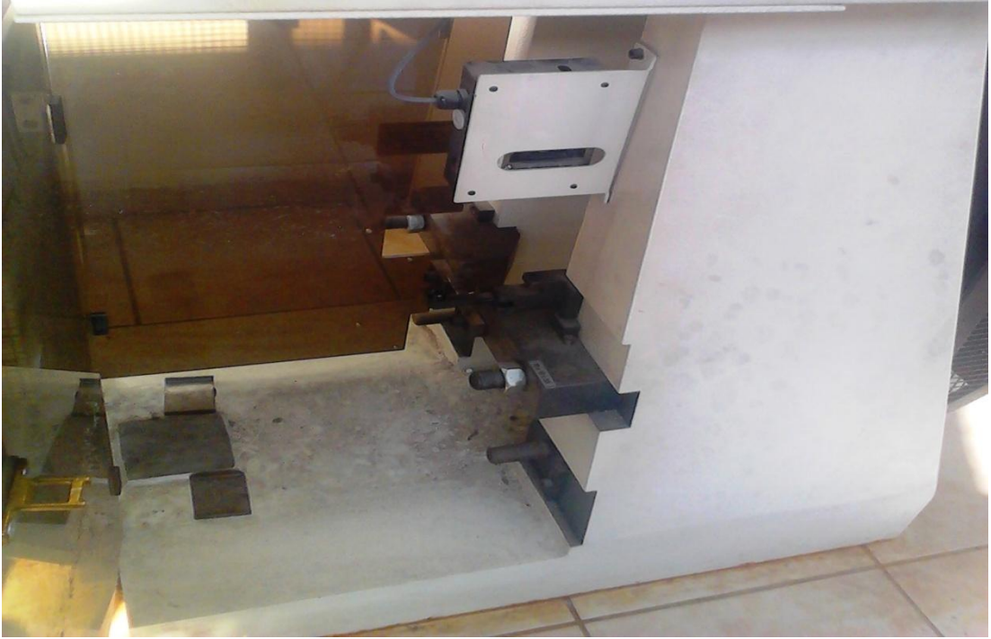
Resim 5.10. Çentik darbe testinde numunenin makinaya yerleştirilmesi
