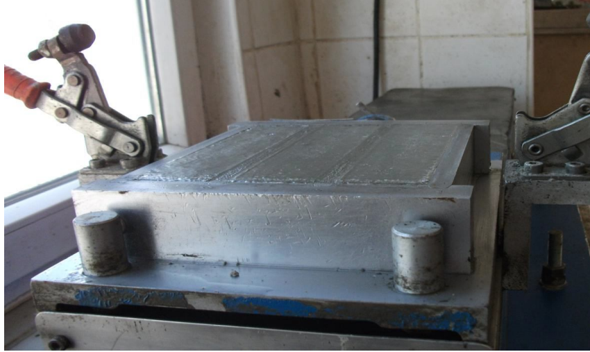
Şekil 3.8 Kalıpların sarsma tablasına yerleştirilmesi
