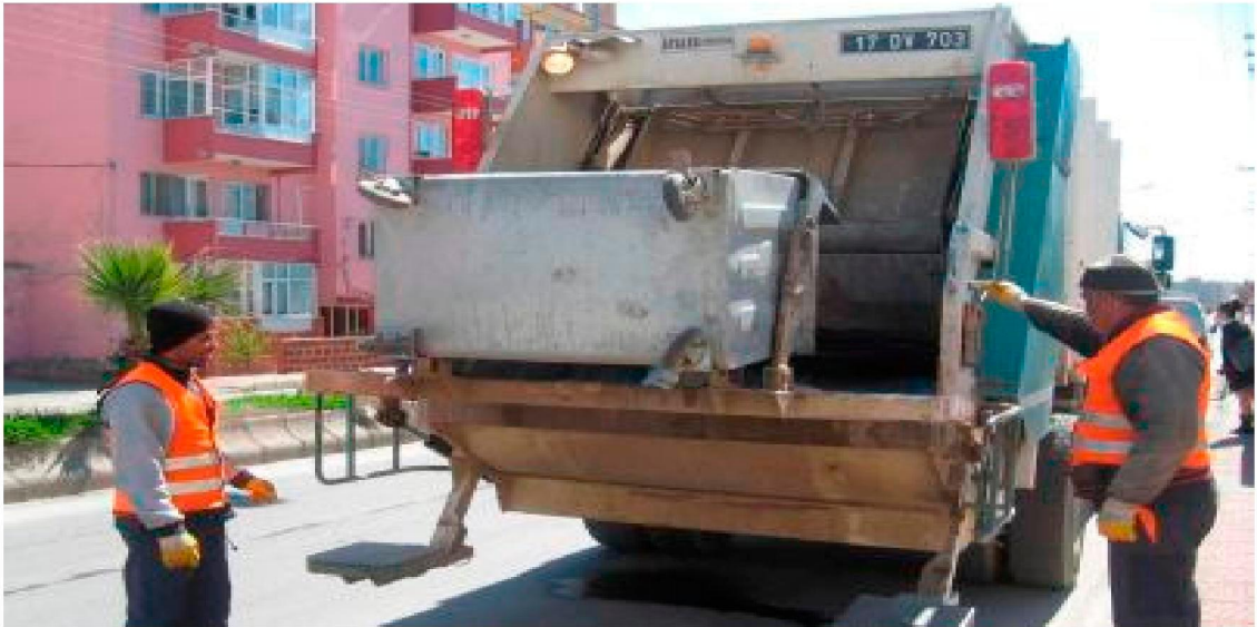
Őekil 3.6 Sıkıřtırmalı p kamyonları ile p konteyneri bořaltım grnts.
