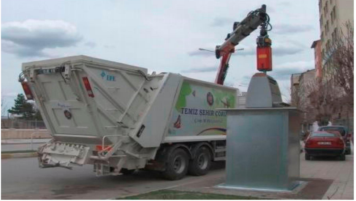
Őekil 3.5 Yer altı konteyner sistemi grnts.
