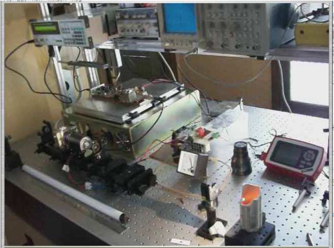
Şekil 4.24 – Lazer sistemiyle kullanımı ve lazerin seramik üzerine delme işlemi.
