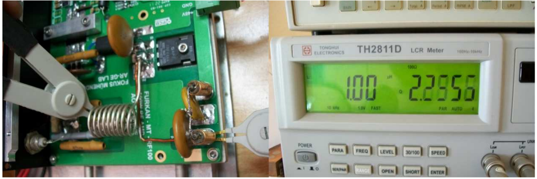
Şekil 4.35 – Ürün tasarımı hassas ayar sonrası bobinin bulunduğu hattın toplam endüktans değeri.
