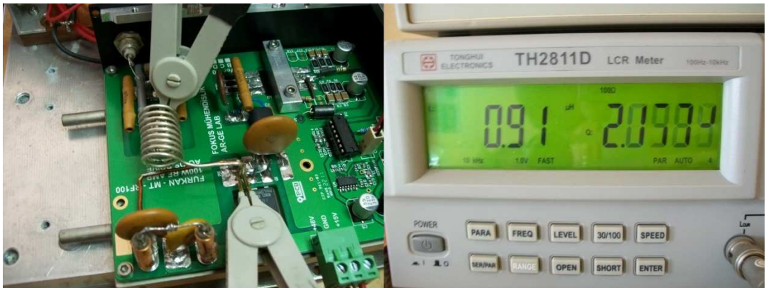
Şekil 4.34 – Ürün tasarımı hassas ayar sonrası bobinin değeri.
