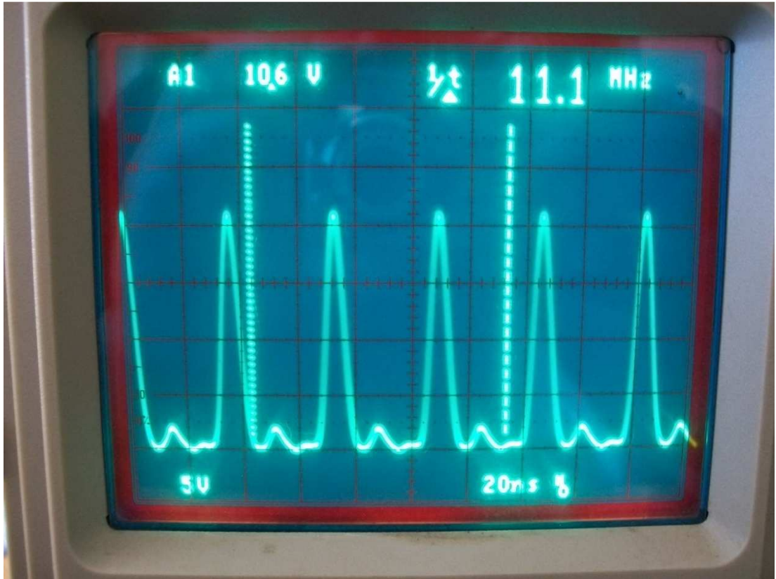
Şekil 4.38 – Ürün tasarımı aktif eleman üzerine düşen gerilim (10x prob).
