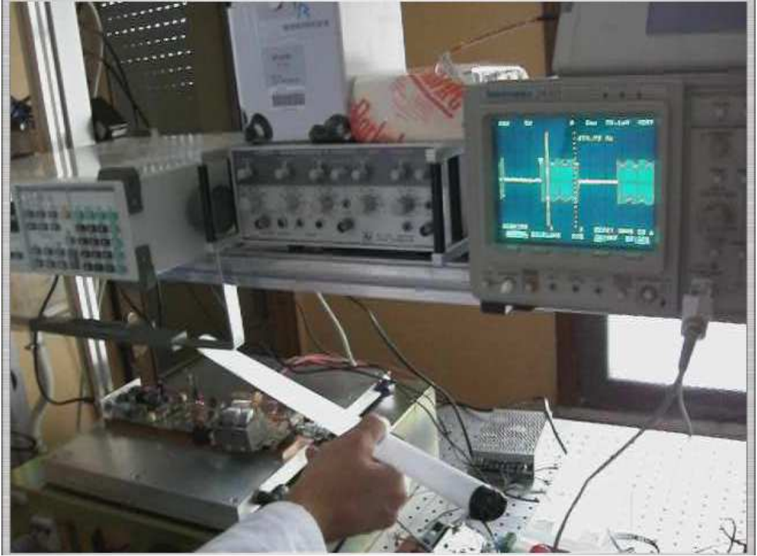
Şekil 4.23 – Lazer sistemin bağlı durumdaki E sınıfı RF-GY'nin testi.
