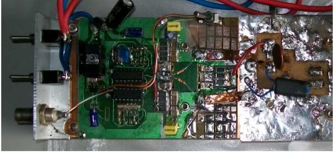
Şekil 4.15 – Prototip tasarımı sinyal üretici ve ön yükselteç görünümü.
