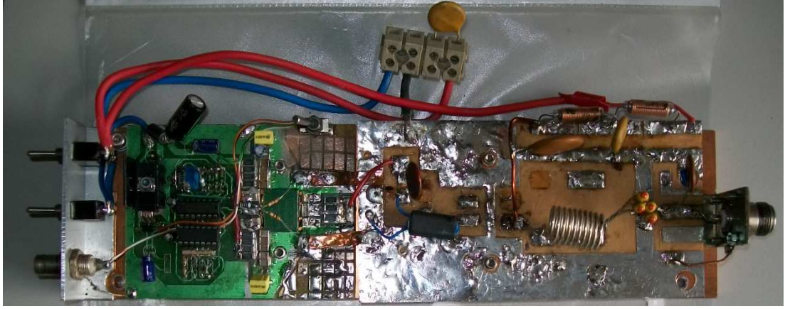
Şekil 4.22 – Prototip tasarımı E sınıfı güç yükselteçli RF jeneratör.
