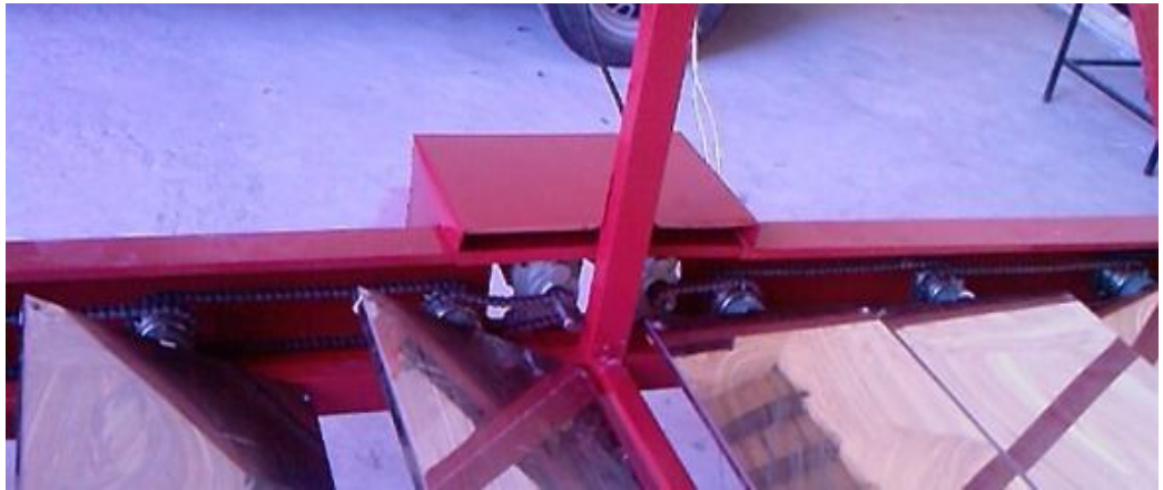
Şekil 5.15. Elektrik motorları ve koruma sacı
