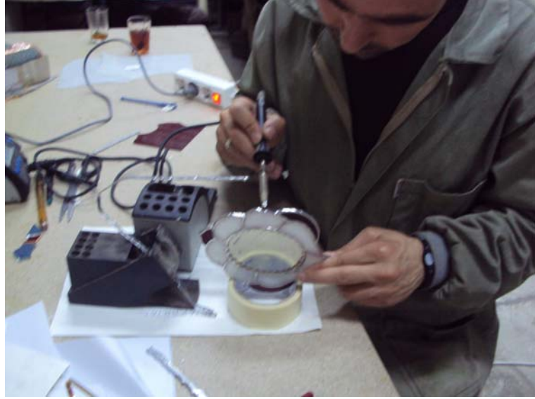
Şekil No: 51 - Vitrayın Kenarlarının Lehimlenmesi
