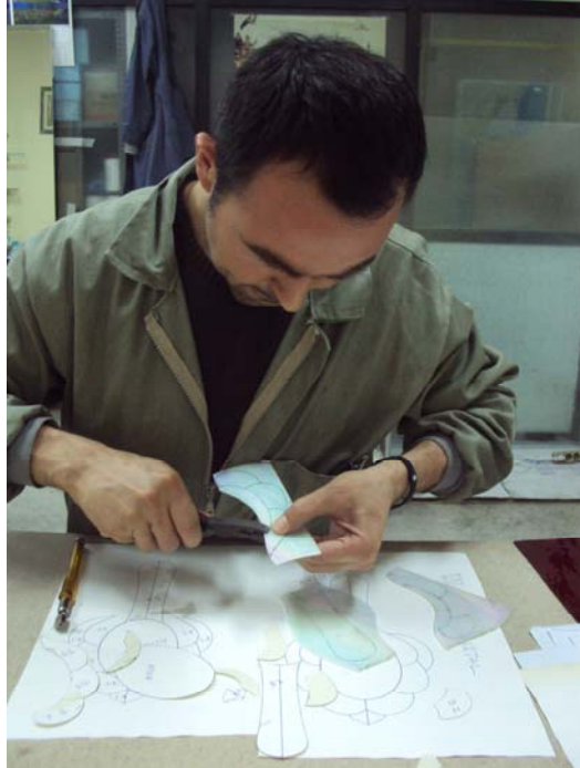
Şekil No: 42 - Camın Pense ile Kırılması
