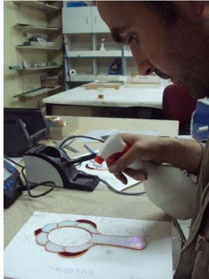
Şekil No: 48 - Camlara Lehim Suyu Sürülmesi
