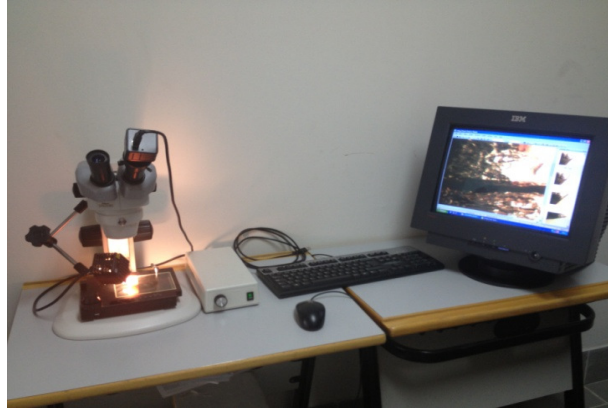
Şekil 3-53: Kenar aralığı ölçümlerinin yapıldığı stereomikroskop
