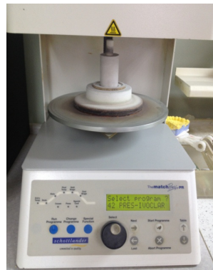
Şekil 3-48: Revetmanın press fırınına alınması
