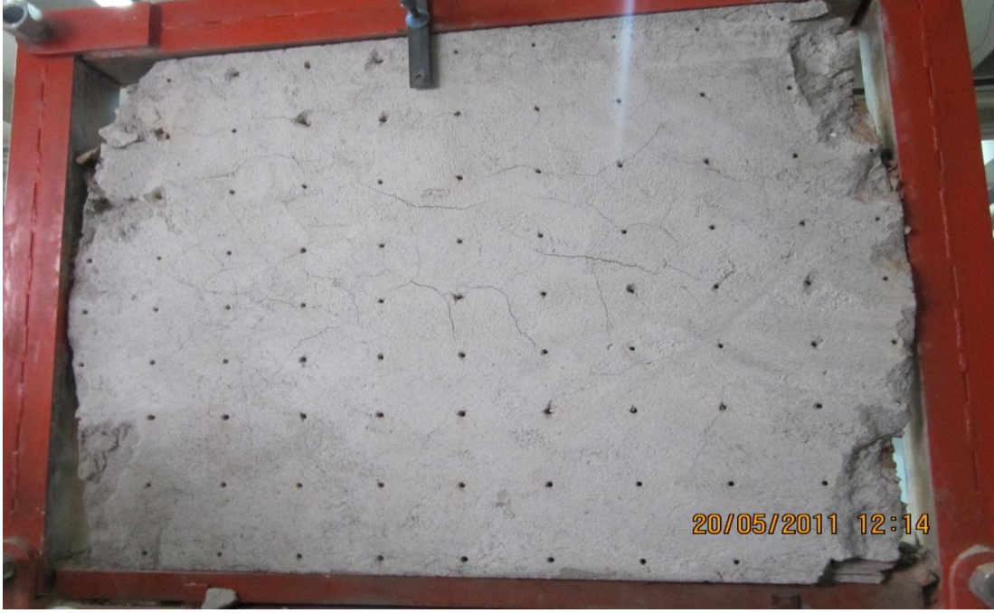
Resim 3.8. S0.5-150 Elemanın deneyden sonraki yalın durumu
