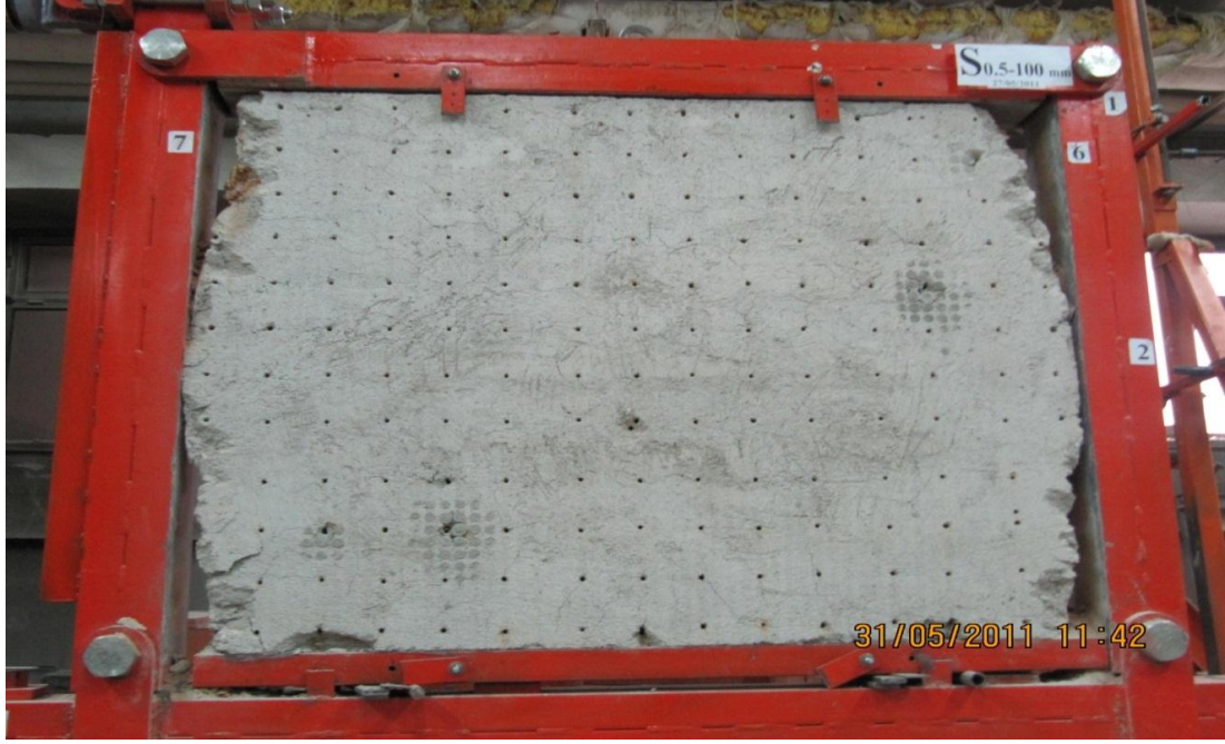
Resim 3.11. S0.5-100 Elemanın deneyden sonraki yalın durumu
