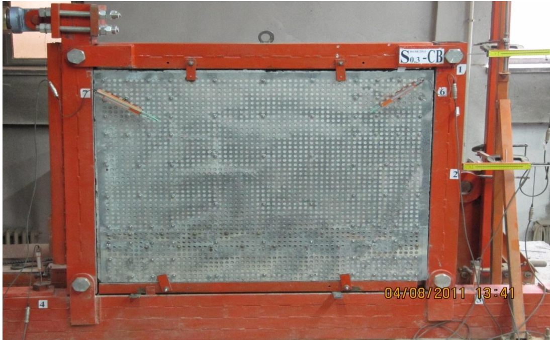
Resim 3.21. S0.3-CB Elemanın deneyden önceki durumu
