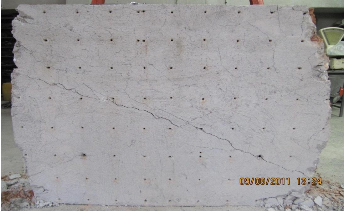
Resim 3.17. S1.0-150 Elemanın deneyden sonraki yalın durumu
