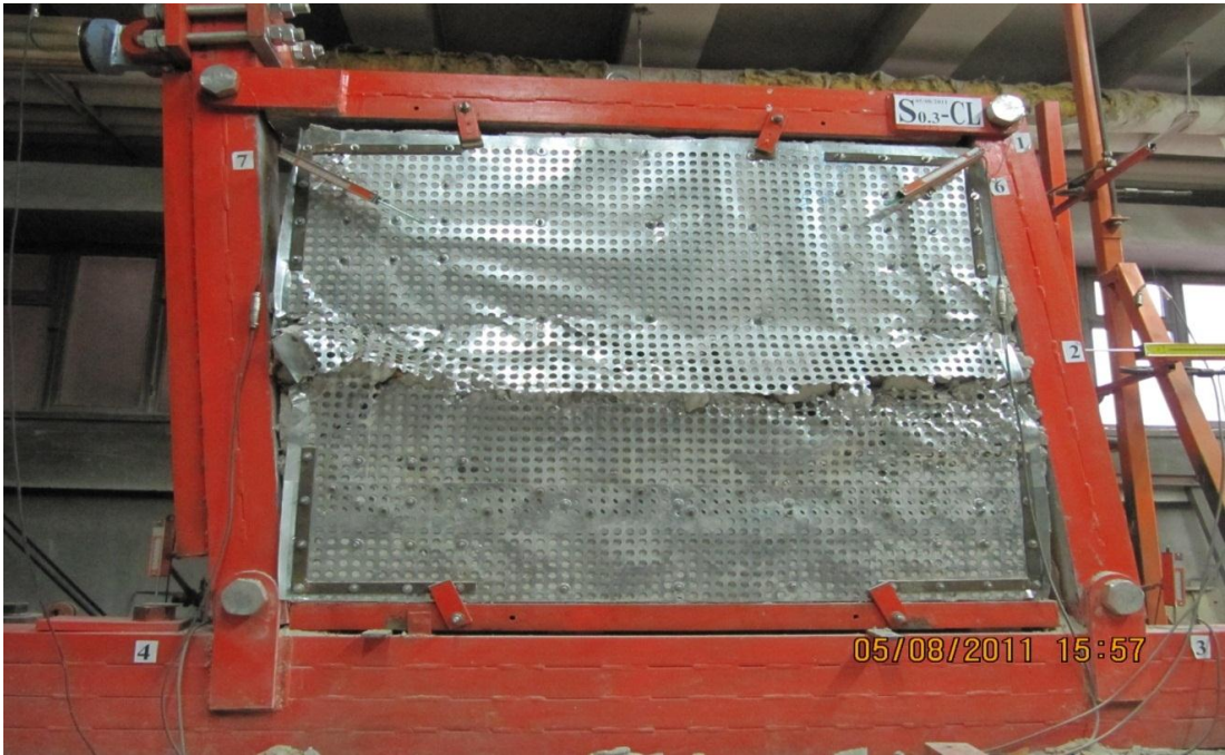
Resim 3.25. S0.3-CL Elemanın deneyden sonraki durumu
