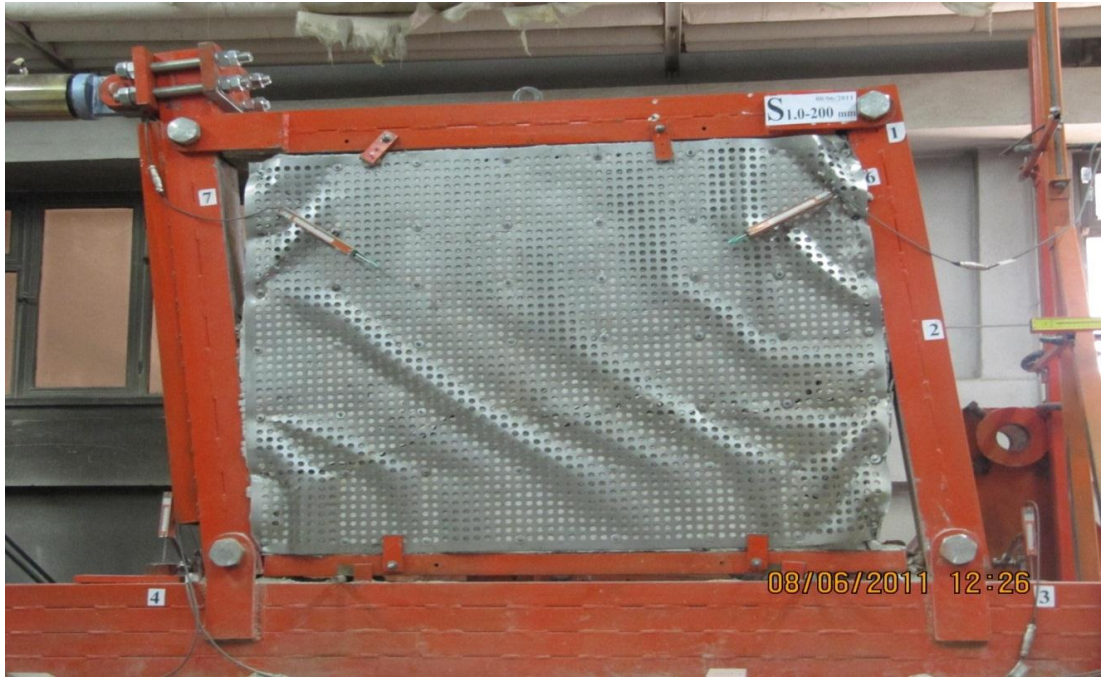
Resim 3.13. S1.0-200 Elemanın deneyden sonraki durumu
