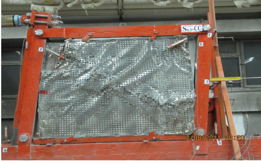
Resim 3.31. S0.5-CC Elemanın deneyden sonraki durumu
