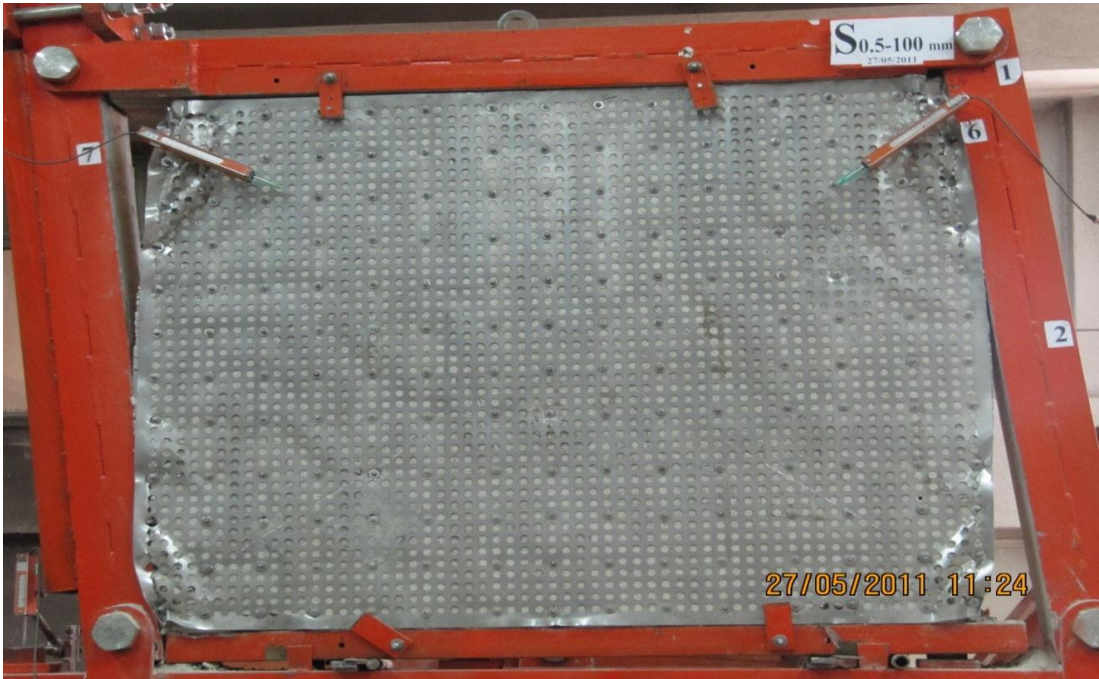
Resim 3.10. S0.5-100 Elemanın deneyden sonraki durumu
