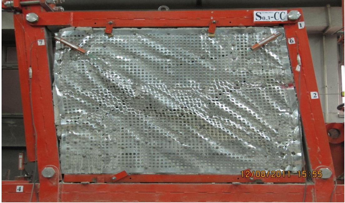
Resim 3.33. S 0.3-CC Elemanın deneyden sonraki durumu
