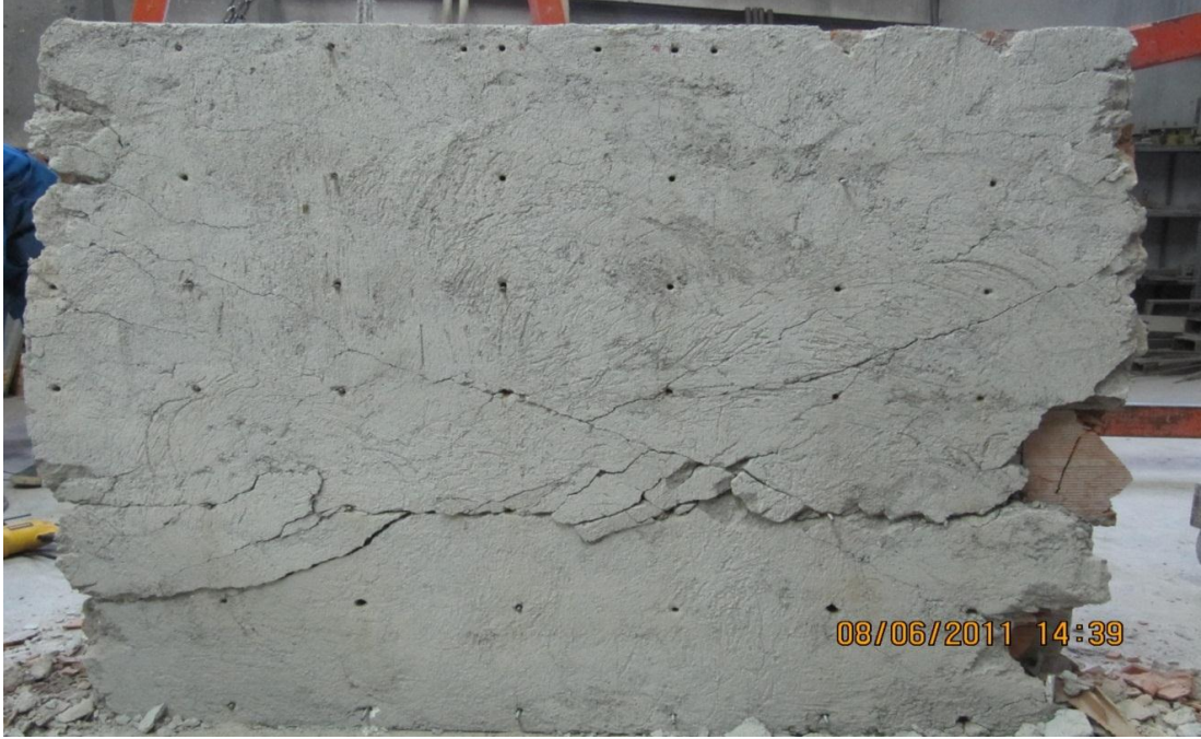
Resim 3.14. S1.0-200 Elemanın deneyden sonraki yalın durumu
