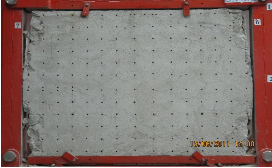
Resim 3.20. S1.0-100 Elemanın deneyden sonraki yalın durumu
