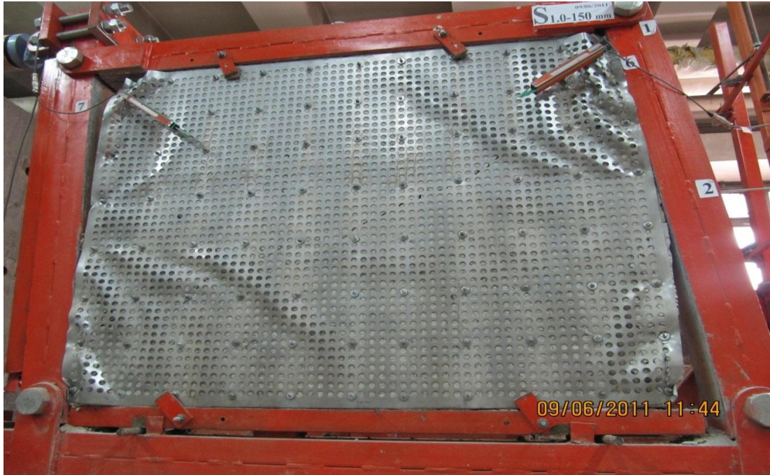
Resim 3.16. S1.0-150 Elemanın deneyden sonraki durumu
