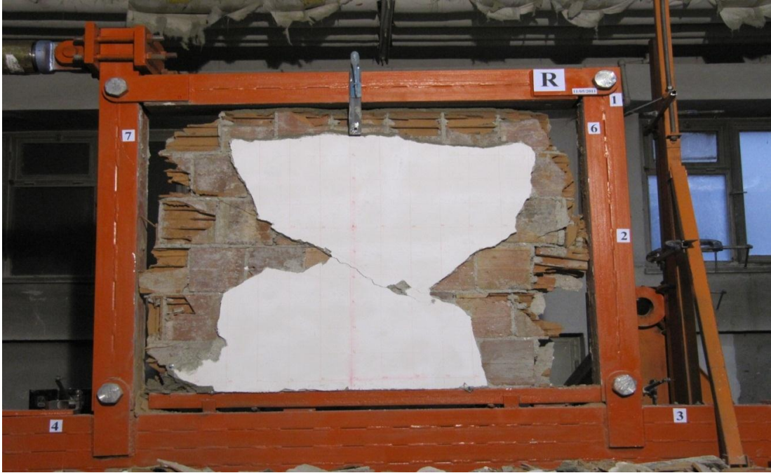
Resim 3.2. Referans elemanın deneyden sonraki durumu
