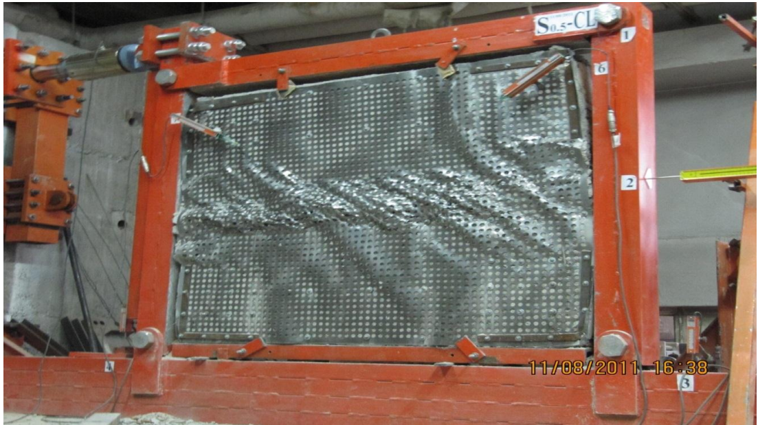
Resim 3.29. S0.5-CL Elemanın deneyden sonraki durumu
