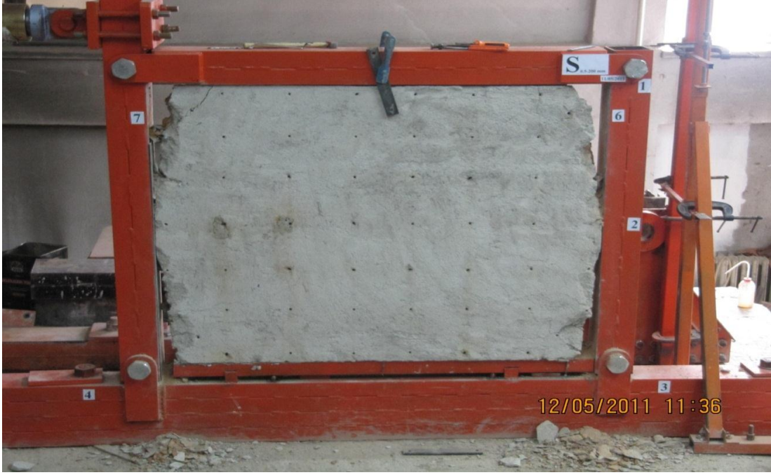
Resim 3.5. S0.5-200 elemanın deneyden sonraki yalın durumu
