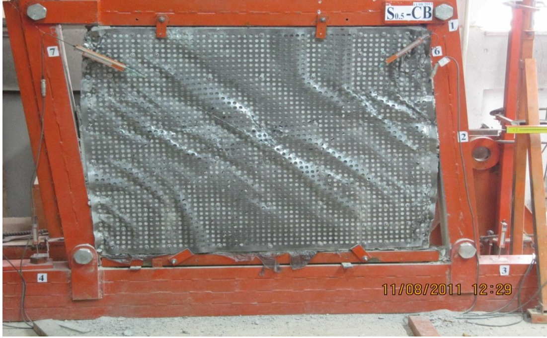
Resim 3.27. S0.5-CB Elemanın deneyden sonraki durumu
