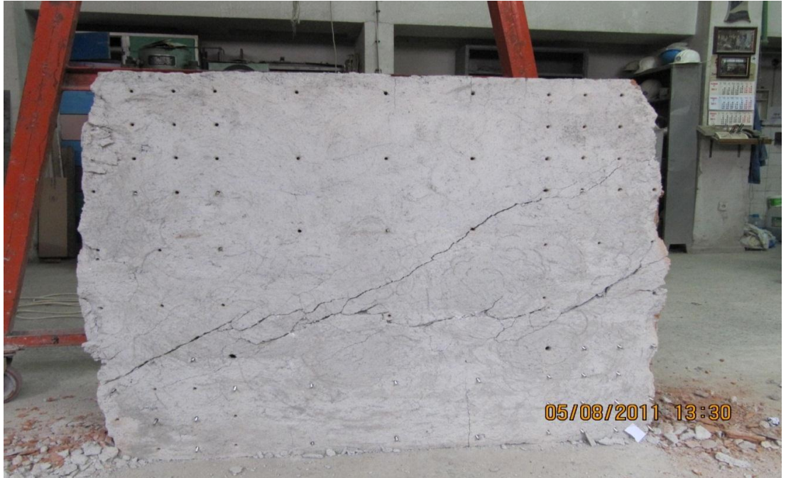
Resim 3.23. S0.3-CB Elemanın deneyden sonraki yalın durumu
