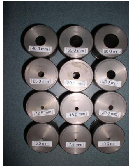
Şekil 2-8 : CyberKnife sistemindeki sabit kolimatörler
