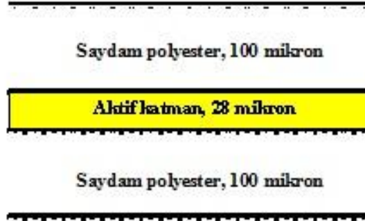
Şekil 3-9: Gafkromik EBT3 filmin şematik görünümü
