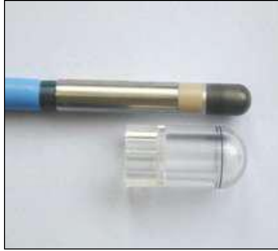
Şekil 3-5: PTW 31010 0,125 cm 3 semiflex iyon odası
