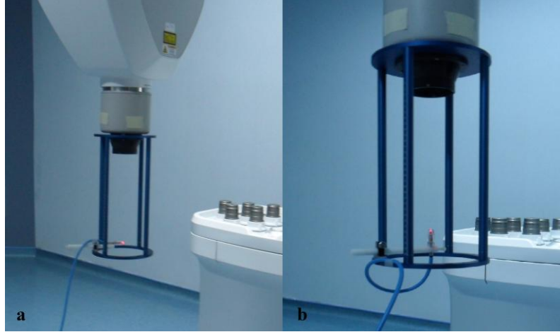
Şekil 3-14: Verim ölçümü için düzenek görüntüsü. (a) Yatay, (b) Dikey pozisyonundaki dedektörü göstermektedir.
