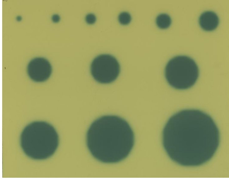
Şekil 3-16: İris kolimatörün tüm boyutlarında ışınlanmış EBT3 filmi. Şekil, 5mm-60mm arasında 12 adet kolimatör için ışınlanmış filmi göstermektedir.
