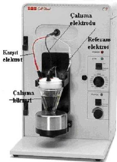
Şekil 3.1. Kaplama ve ölçümde kullanılan hücre sistemi
