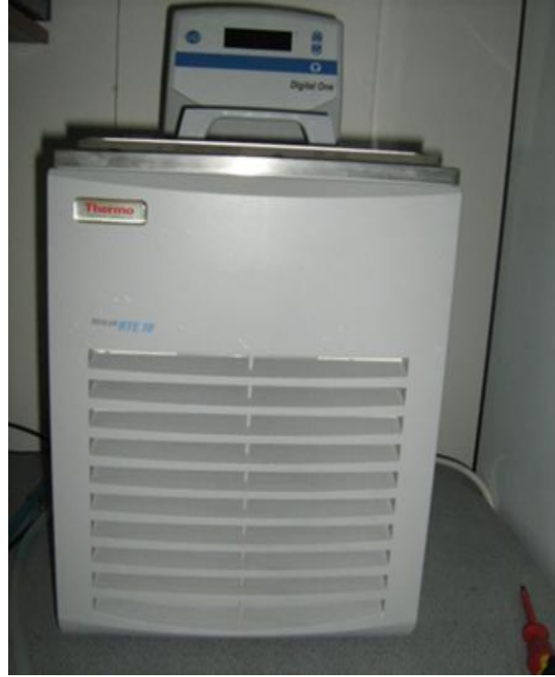
Şekil 12 Endüktif modüllü RF jeneratöründeki kullanılan kriyostat ünitesi
