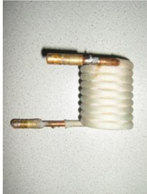
Şekil 13 Endüktif RF jeneratörünün bobin görüntüsü
