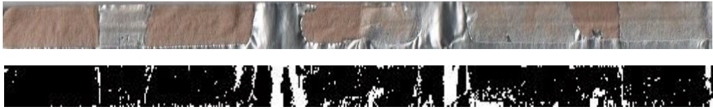
Şekil 3.15. Otsu yöntemi ile yapılan eşikleme
