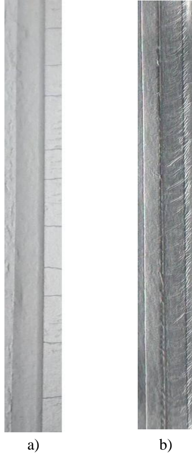
Şekil 3.3. Boyuna dikişler için sıcaklık ve basınç değerleri ile oluşan hatalar
