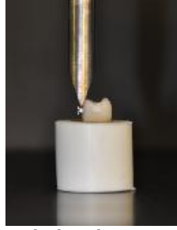
Şekil 3.12. Kesme ucunun, koparma kuvveti braket tabanına paralel olacak şekilde konumlandırılışı
