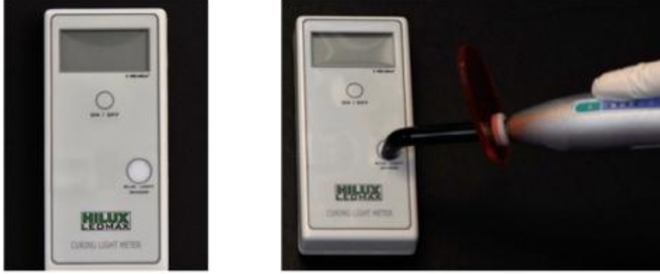
Şekil 3.4 Işık yoğunluğunu ölçen Ledmax ışık ölçer aygıtı ve kullanılış şekli
