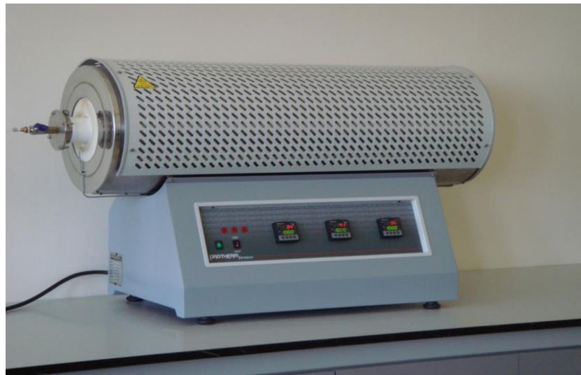
Şekil 3.1. Tavlama işleminin yapıldığı fırın
