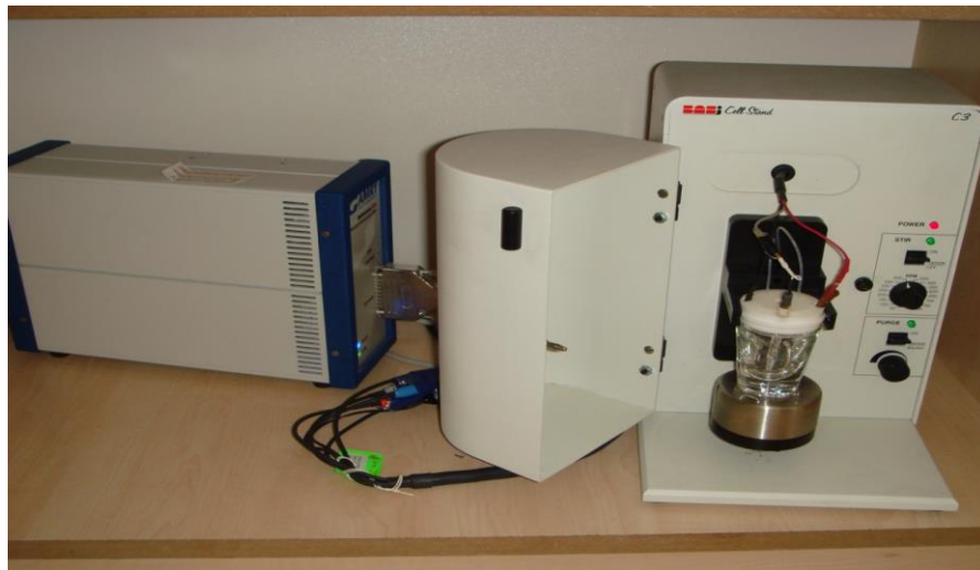
Şekil 3.2. Elektrokimyasal ince film büyütme sistemi
