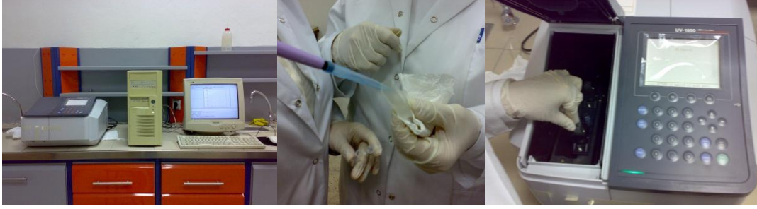
Şekil 2.5. DNA'nın miktar ve saflığının spektrofotometrik olarak belirlenmesi
