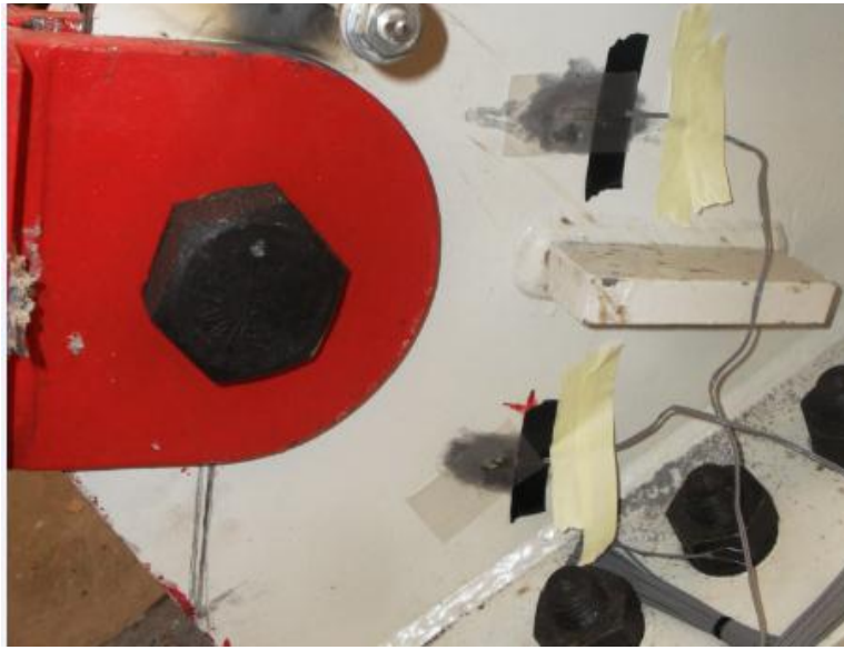
Şekil 3.23 : Bayrak levhasına strain-gauge yerleşimi.
