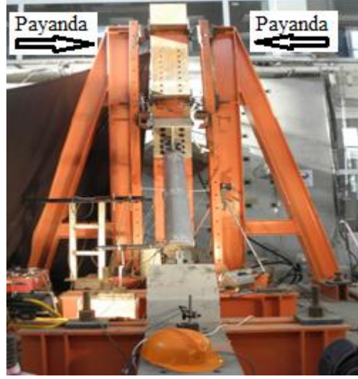
Şekil 2.1 : (a) Deney düzeneğinin üç boyutlu genel görünüşü (Haydaroğlu ve diğ., 2010). (b) Düzlem dışı hareketi engelleyen çift taraflı çelik payandalar (Karataş ve Çelik, 2012).
