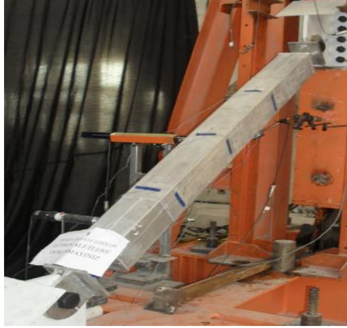
Şekil 3.24 : Çapraz dış tüp boyunca strain-gauges yerleşimi.
