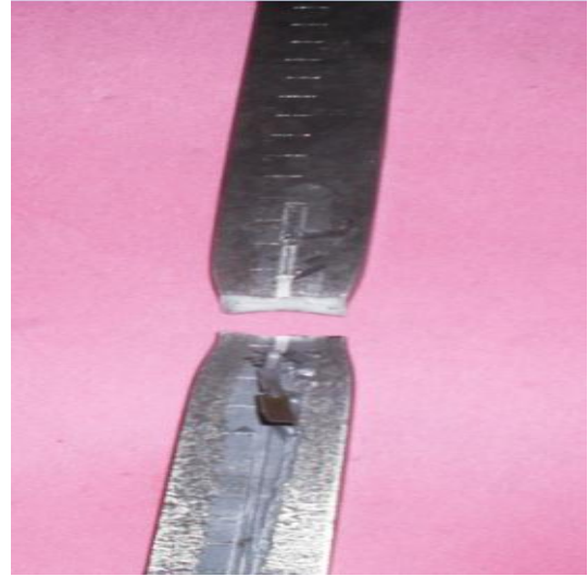
Şekil 2.9 : Kanallı çekme numunelerinde deney sırasında oluşan kesit daralması.
