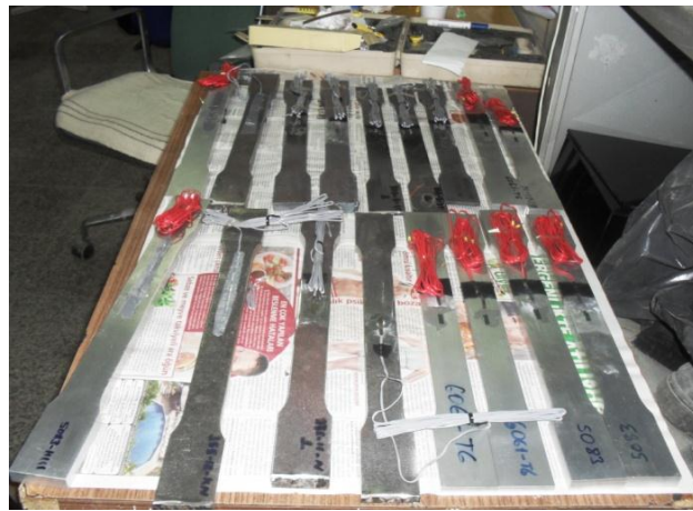
Şekil 2.7 : Strain-gauge yapıştırılan 19 adet çekme numunesi.
