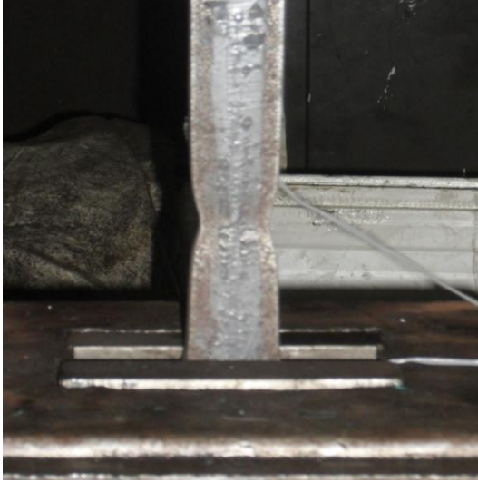
Şekil 2.9 : Kanallı çekme numunelerinde deney sırasında oluşan kesit daralması.
