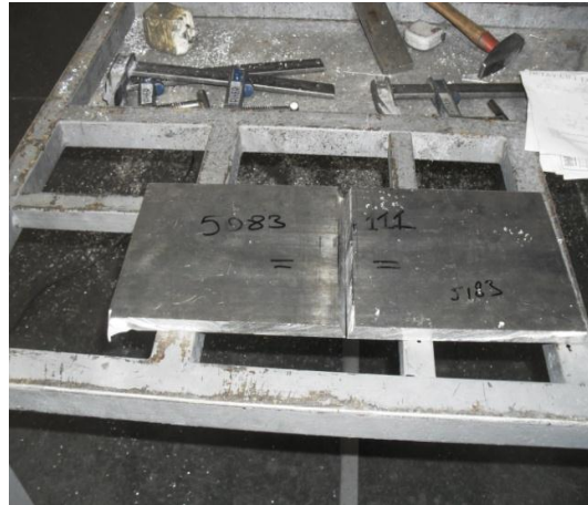
Şekil 2.16 : (a) Çekme numunelerinin çıkarılacağı plakalara açılan küt alın kaynağı. (b) Kaynak ağzı açılmış A5083-H111 plakası.
