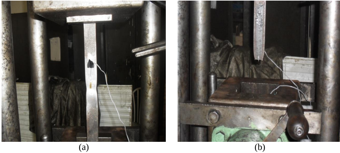
Şekil 2.8 : (a) Yerel boğumların olduğu noktalarda uzama sonucu kesit daralmaktadır. (b) Çekme deneyi sonucu kopan çekme deney parçası.
