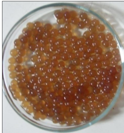
Şekil 2.6. Konsantre enzim çözeltisinin alginat ile tutuklanması ile elde edilen boncuklar
