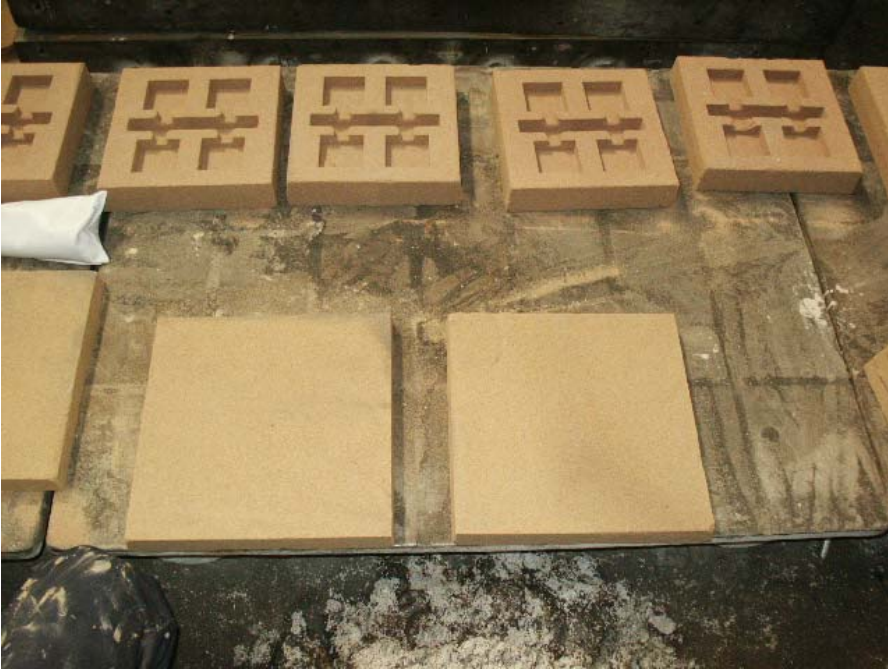
Resim 6.2. Alfaset Reçine bağlayıcılı silis kumu ile üretilen kalıplar.
