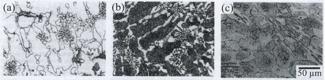
Şekil 4.31.15Cr-3Mo beyaz dökme demir alaşımlarının; a) döküm halinde, b) 1000°C, c)1100°C’ de 2 saat destabilizasyon işlemi sonrası mikroyapıları [21]
