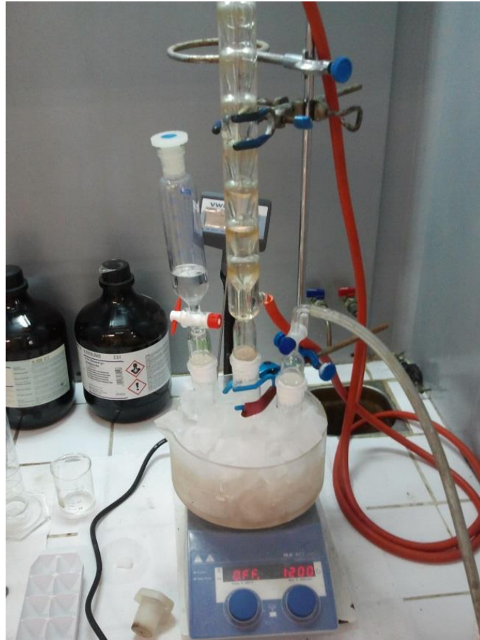
Şekil 2.2. Siyanat ester sentezlerinin reaksiyon düzeneği
